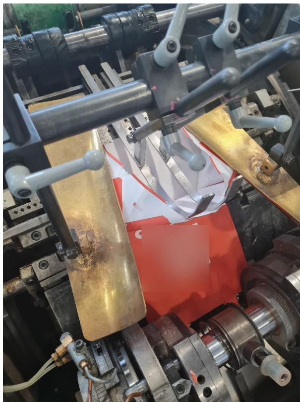
Slika 9.11. Prolazak poluformiranog dna kroz mesingane plate „skije“
