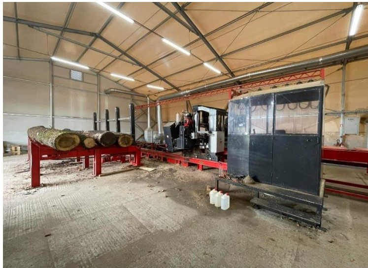
Slika 11. Rampa sa trupcima i pokretna pila
