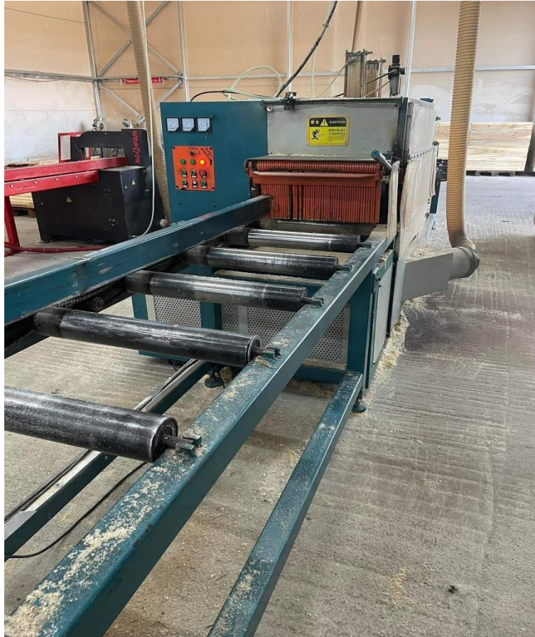
Slika 13. Više lisna pila za daske i lege
