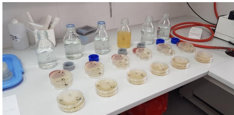
Slika 4.2. Priprema uzoraka vode za mikrobiološku analizu sukladno „Pravilniku o parametrima sukladnosti, metodama analize, monitoringu i planovima sigurnosti vode za ljudsku potrošnju te načinu vođenja registra pravnih osoba koje obavljaju djelatnost javne vodopskrbe“
