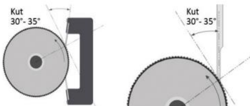
Slika 2.7 Kut noža za odstranjivanje viška bojila u odnosu na aniloks valjak
