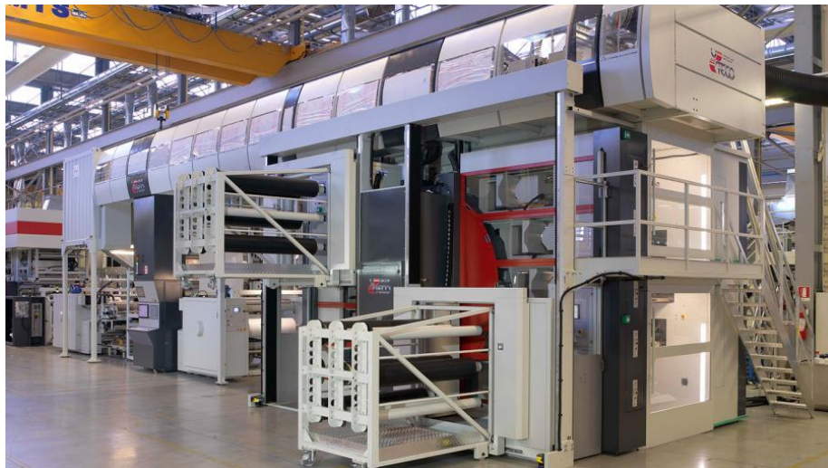
Slika 2.10 Diamond HP s 10 tiskovnih jedinica proizvođača Uteco
