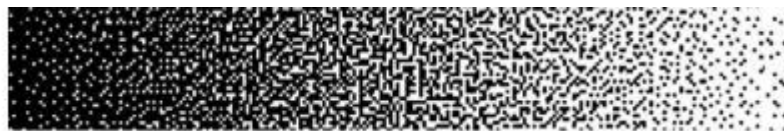
Slika 7.3 Frekventno modulirani (FM) raster
