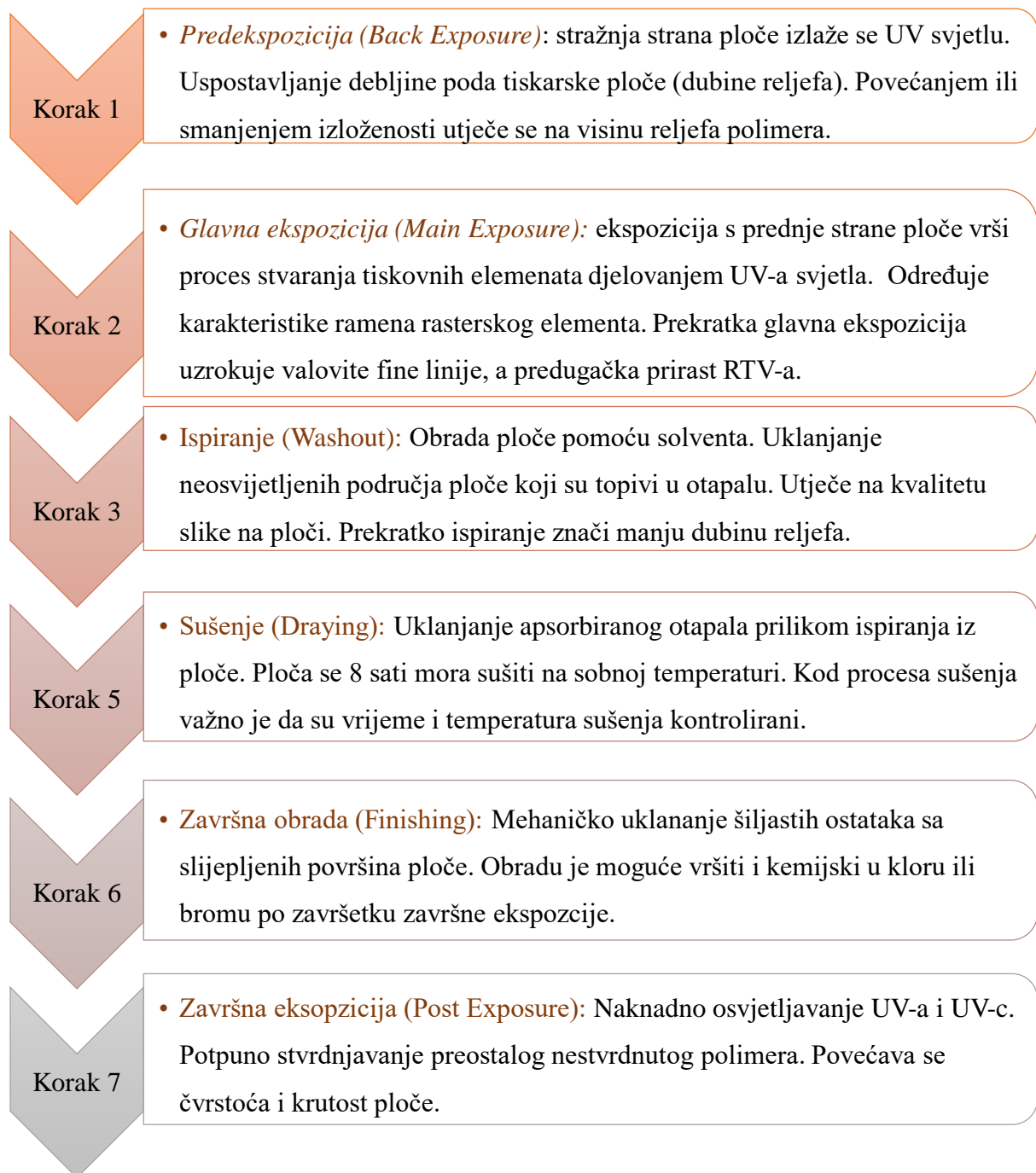
Slika 5.6 Solventni postupak izrade fotopolimerne ploče, izradio autor prema Valdec, D.
