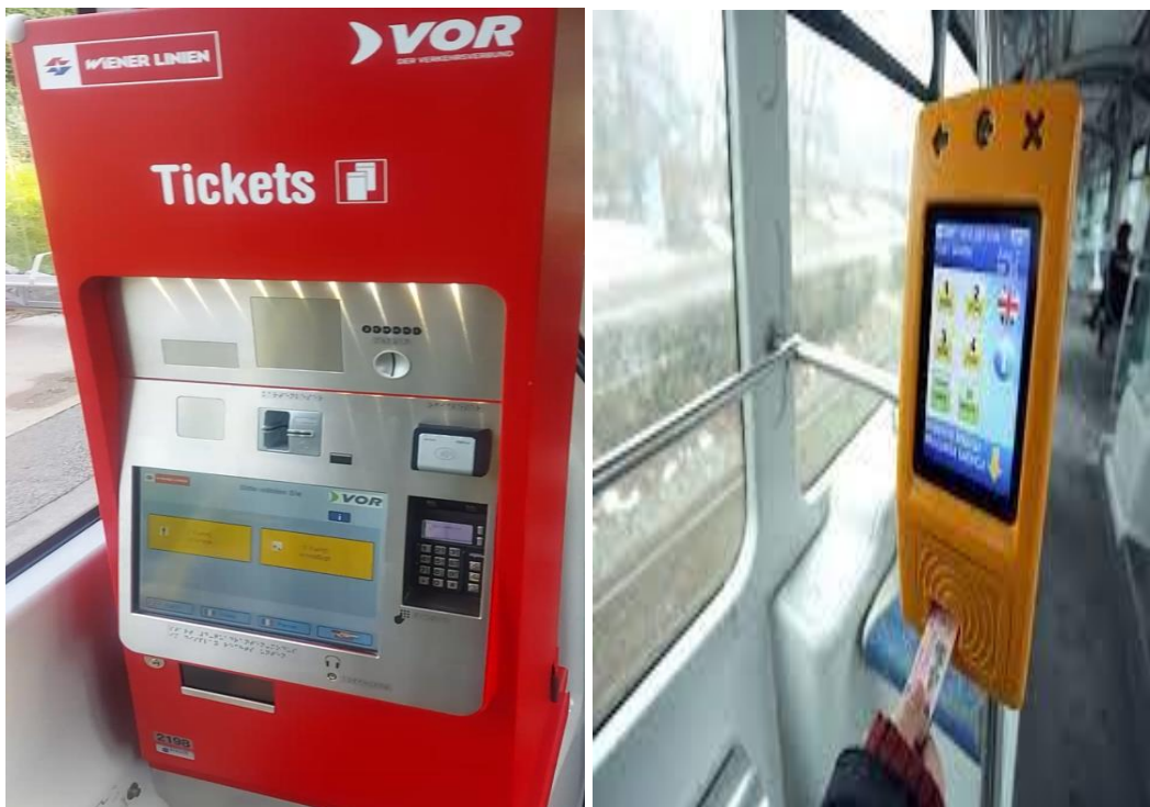
Slika 43: Aparat za kupnju karata u tramvaju u Beču i poništivač karata u ZET-u, slikala autorica
