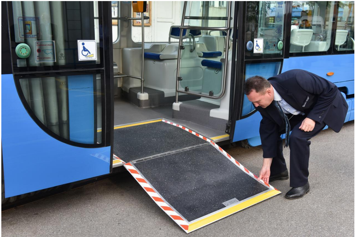
Slika 45: Rampa u niskopodnom tramvaju; izvor: www.vecernji.hr/ dostupno 18.03.2022.
