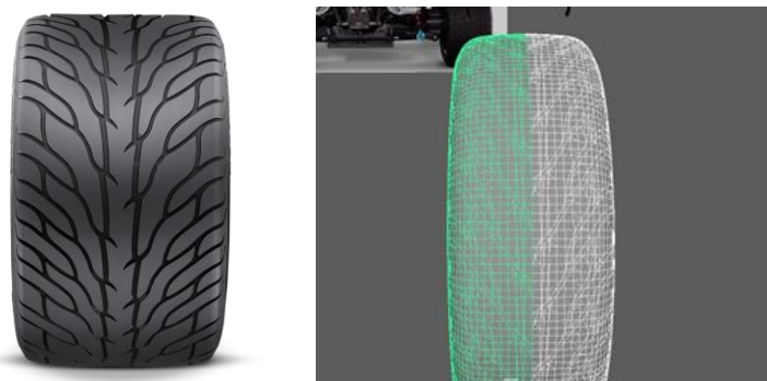
Slika 29 Referenca gume i modelirana guma
