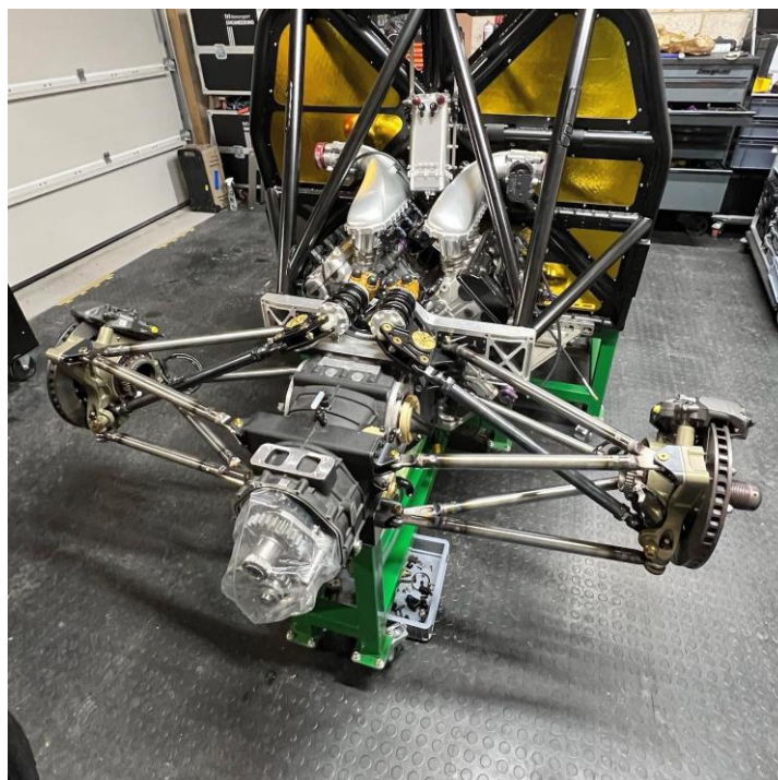
Slika 36 Prikaz stvarne suspenzije
