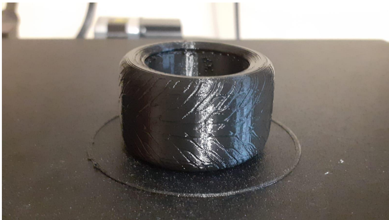
Slika 69 Prikaz stražnje isprintane gume
