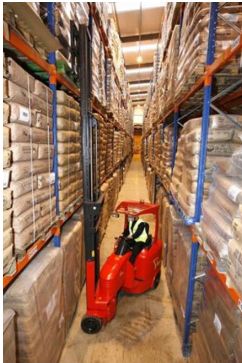
Slika 3.3.: Viličar sa zakretnim jarbolom (Flexi AC 1000/1100) [20]
