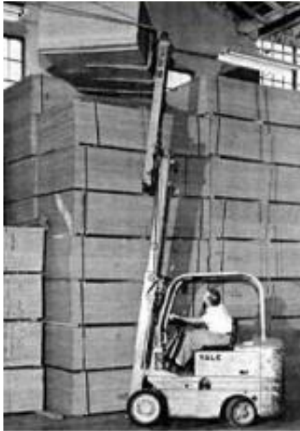
Slika 2.4.:Viličar sa vilicama i povišenim jarbolom [17]
