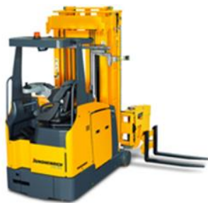
Slika 4.5.: Viličar Jungheinrich za vrlo uske prolaze [8]
