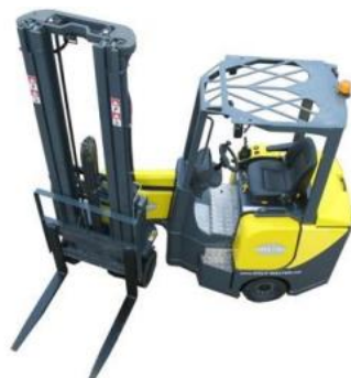
Slika 3.4.: Viličar sa okretnom prednjom osovinom [22]
