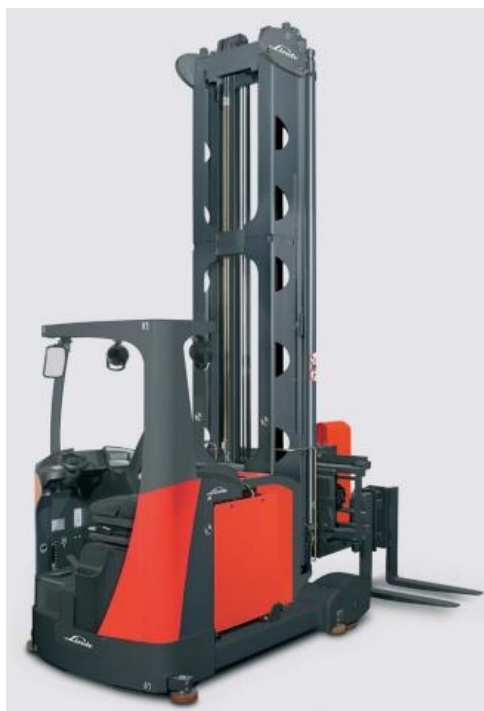
Slika 4.3.: Električni viličar u izvedbi „čovjek-dolje“ nosivosti do 1350 kg serije „A“ [26]
