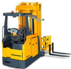
Slika 4.5.: Viličar Jungheinrich za vrlo uske prolaze [8]
