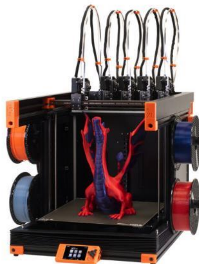
Slika 5.2 Najnoviji model Prusa XL pisača koji će moći imati čak do 5 ekstrudera
