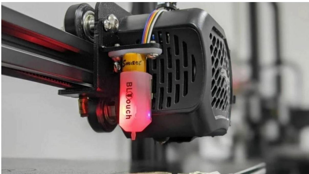
Slika 5.2.4 BLTouch senzor za automatsko ravnanje podloge
