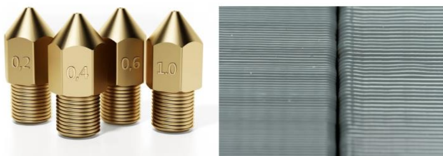
Slika 5.2.1 Nozzli (lijevo) i razlika u visini slojeva (desno)
