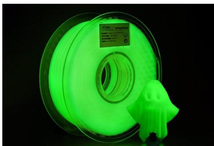
Slika 5.3.2 Filament koji svjetli u mraku
