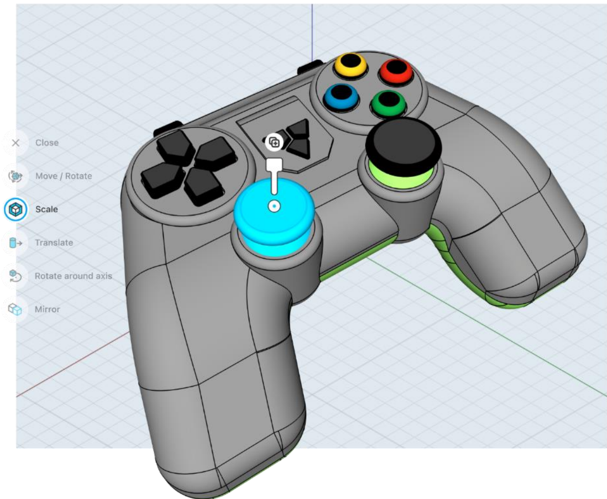
Slika 3.2.6 Primjer korištenja Shapr3Da za izradu prototipa proizvoda
