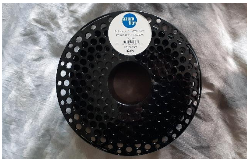
Slika 7.15 PLA crni filament tvrtke AzureFilm korišten za ispis
