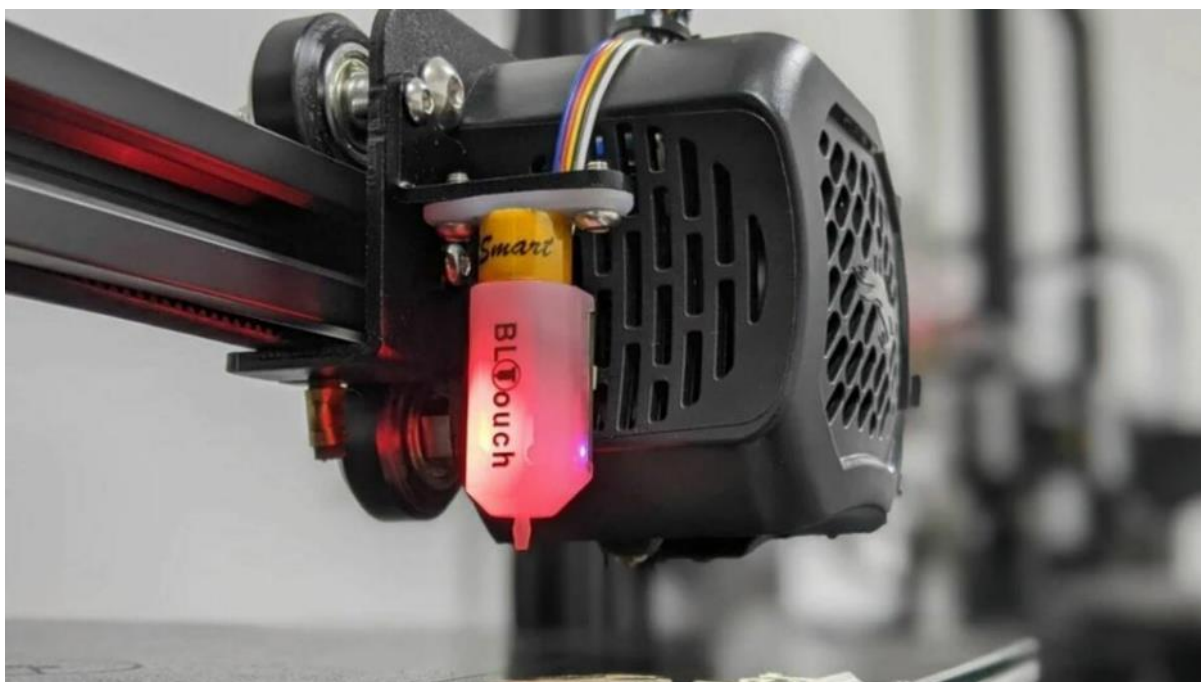
Slika 5.2.4 BLTouch senzor za automatsko ravnanje podloge
