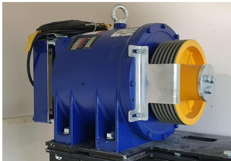
*Slika 7. Sinkroni motor s permanentnim magnetima*
