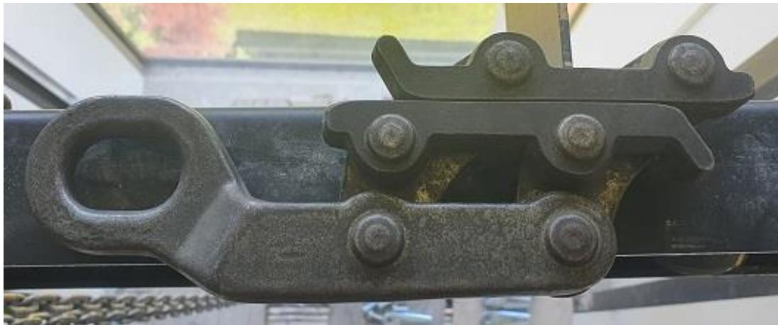
Slika 34. Alat za montažu čelične užadi [3]
