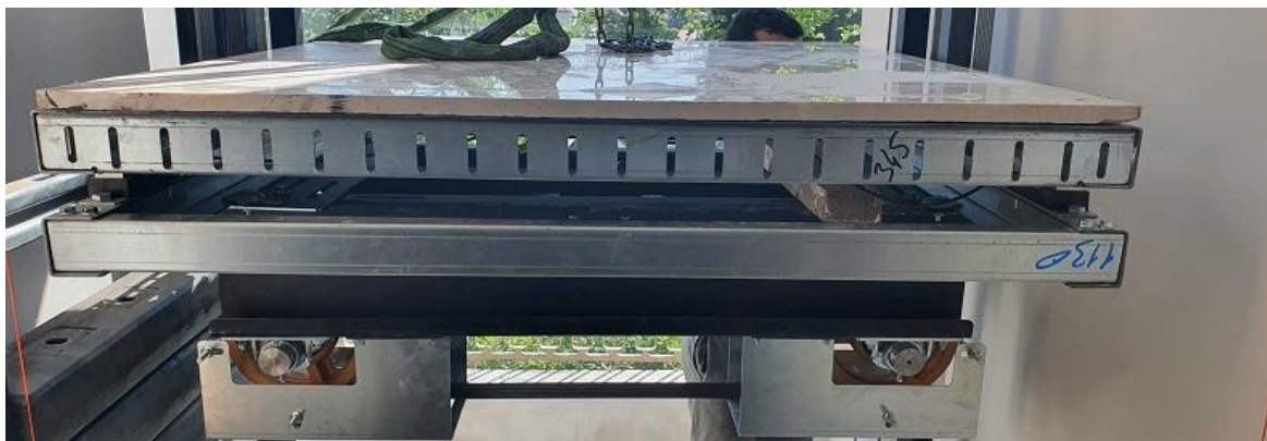
Slika 21. Pod kabine dizala [3]
