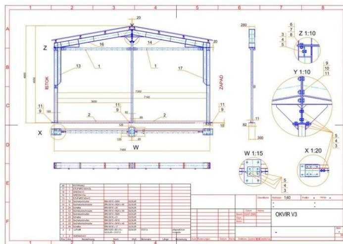
Slika 3. Primjer radioničkog nacrtu čelične konstrukcije, ( izvor: WEB)
