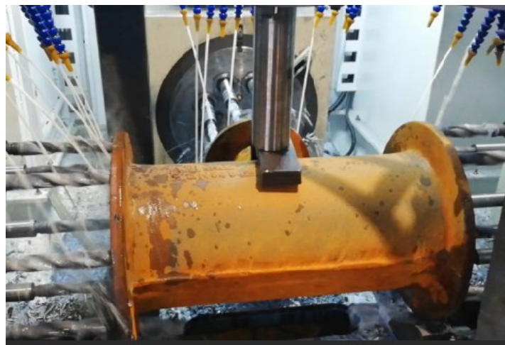
Slika 85 Stezanje komada hidrauličkim cilindrom
