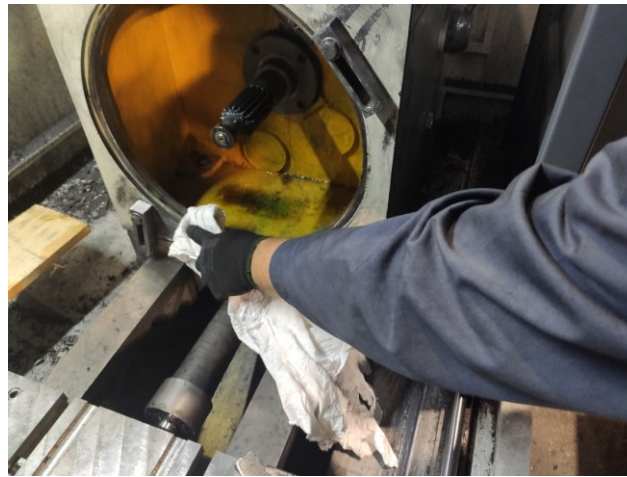
Slika 79 Čišćenje površina za prstene ili površina na prstenu
