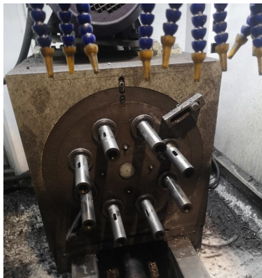
Slika 71 Glava za bušenje prije čišćenja
