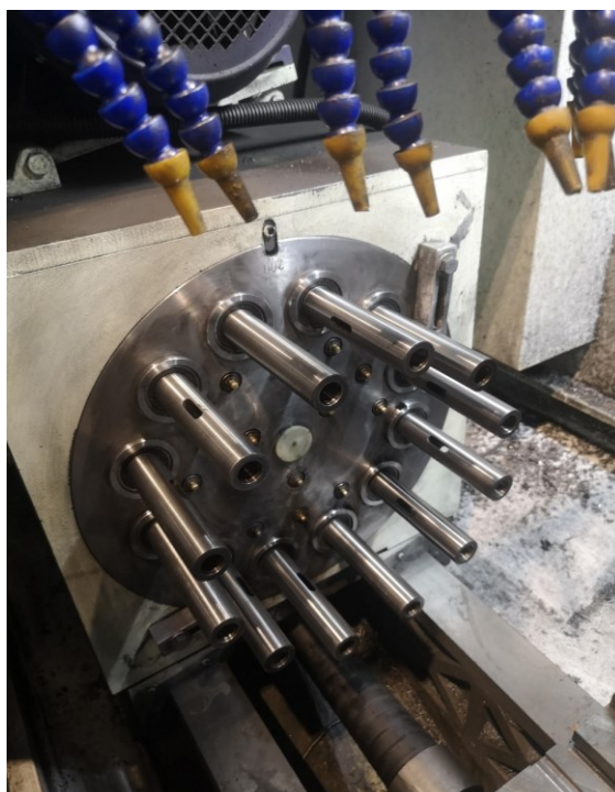
Slika 74 Glava za bušenje nakon čišćenja
