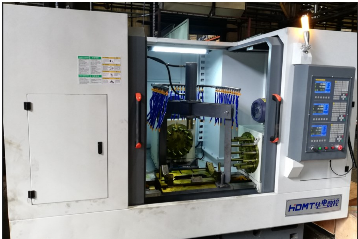
Slika 13 Tripleks bušilica HDMT [10]
