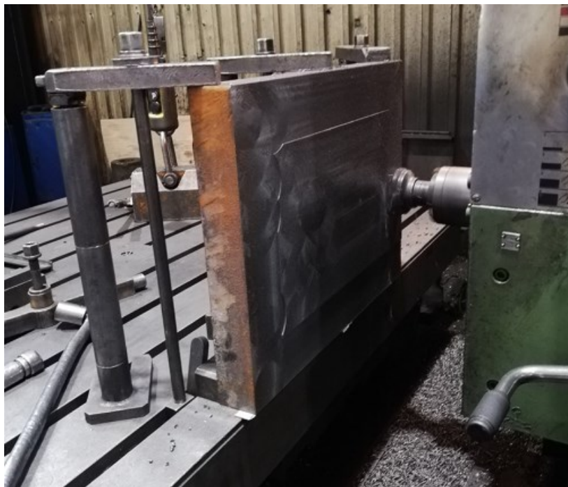
Slika 65 Poravnavanje stranica ploče
