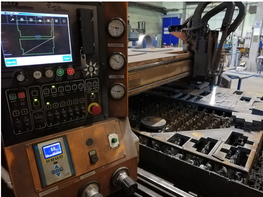
Slika 47 Rezanje ploče na plazma rezaču
