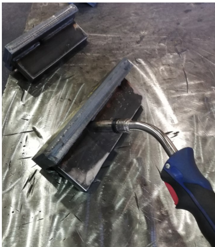
Slika 49 Zavarivanje pozicija prizme
