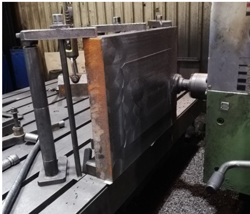
Slika 65 Poravnavanje stranica ploče
