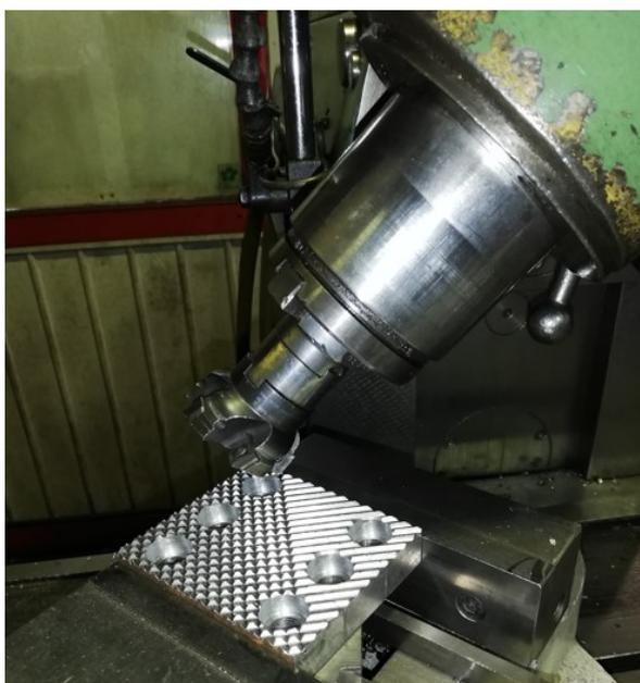
*Slika 68 Glodanje kanala na čeljustima*
