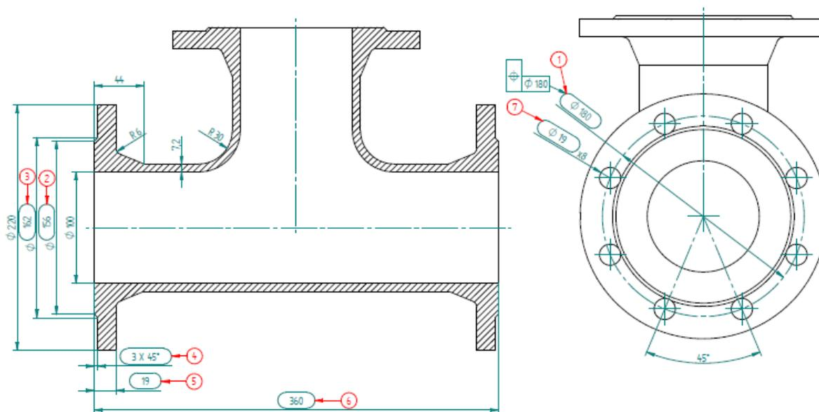
Slika 94 Dimenzije T komada prema HRN EN 1092-2
