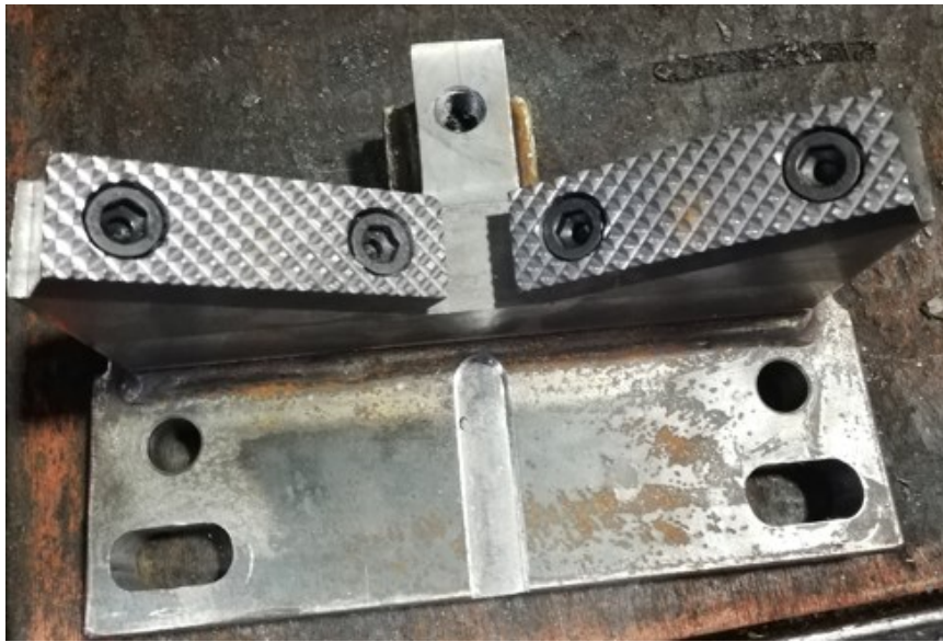
Slika 69 Montirane čeljusti na prizmu
