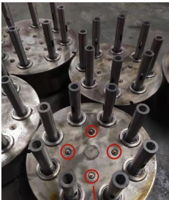
*Slika 26 Podmazivanje glave za bušenje [10]*
