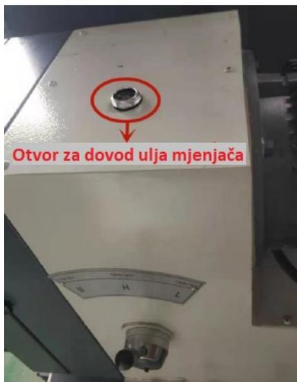
Slika 23 Dovod ulja mjenjača [10]
