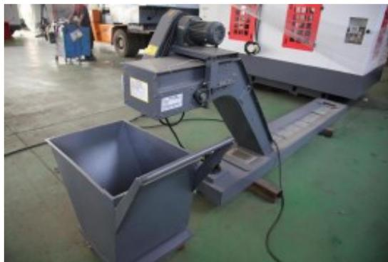
*Slika 20 Transporter za uklanjanje strugotine [10]*
