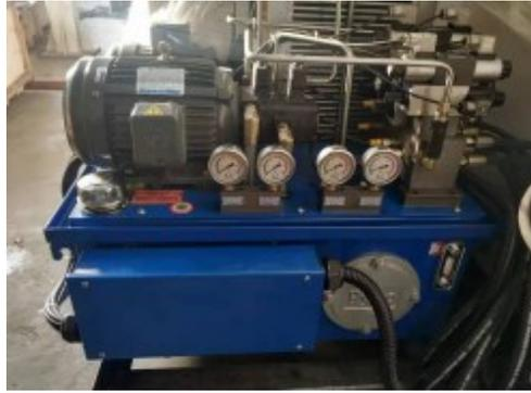
*Slika 18 Hidraulična stanica [10]*
