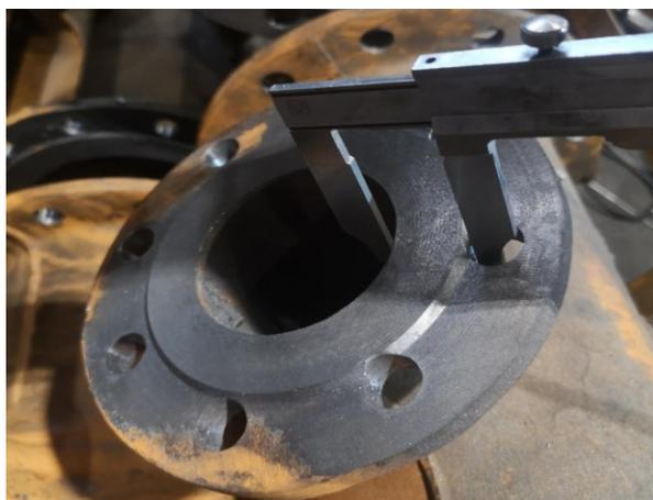
*Slika 89 Mjerenje provrta*
