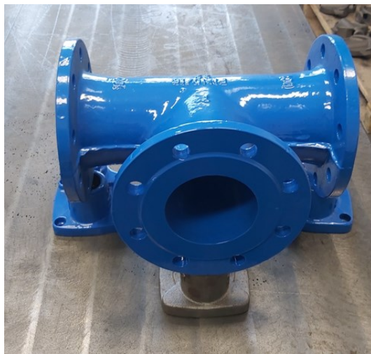
Slika 90 T komad na mjernome stolu
