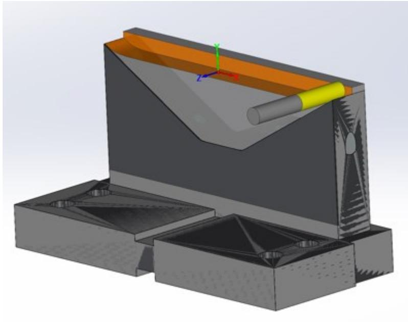
*Slika 54 Simulacija grube obrade*
