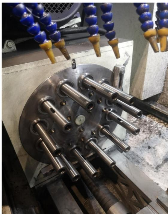
*Slika 74 Glava za bušenje nakon čišćenja*
