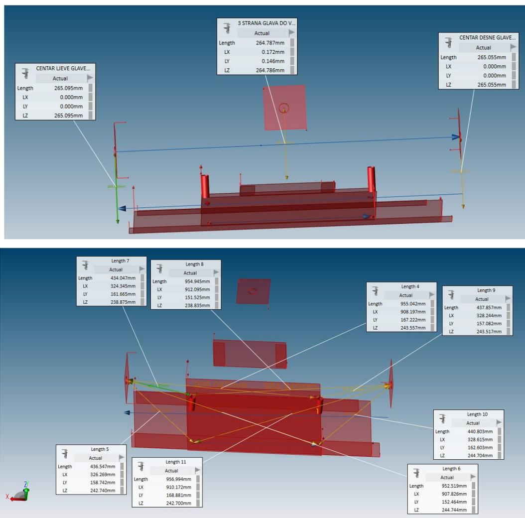
Slika 29 Izmjerene udaljenosti centra lijeve i desne glave
