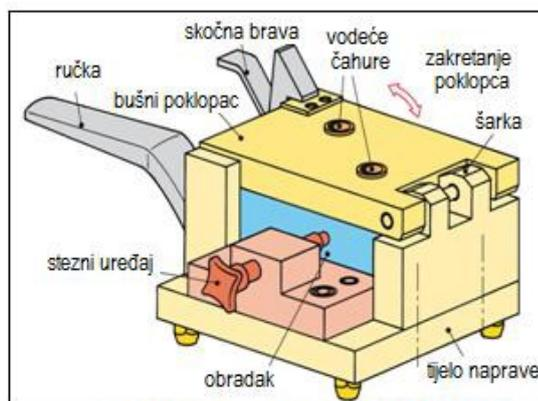
Slika 3 Naprava s zakretnim bušenim poklopcem [5]
