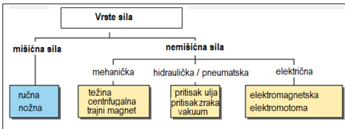
Slika 7 Vrste sila stezanja prema načinu proizvodnje [5]
