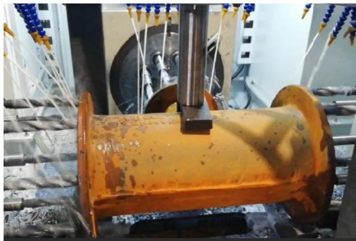
*Slika 85 Stezanje komada hidrauličkim cilindrom*
