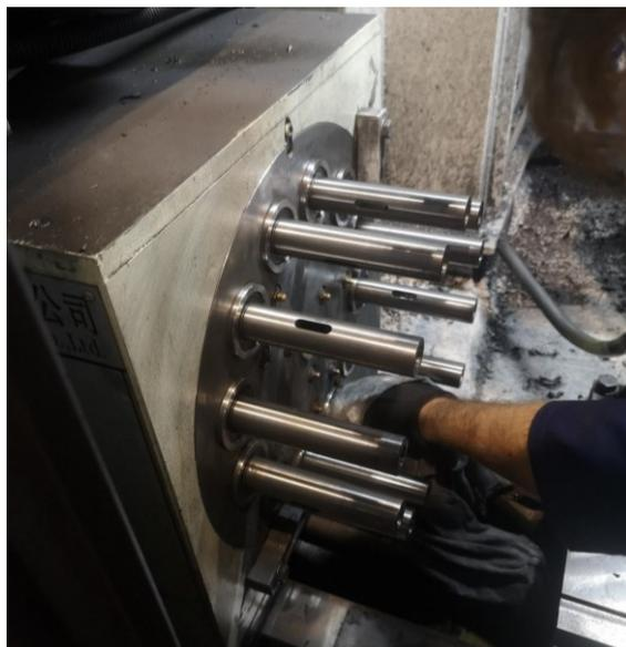
*Slika 73 Čišćenje glave za bušenje*
