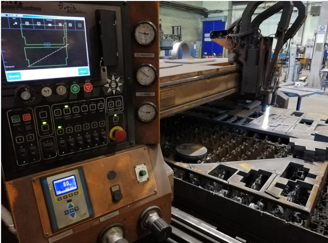
*Slika 47 Rezanje ploče na plazma rezaču*
