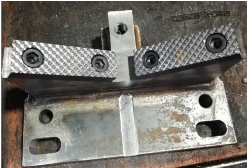
Slika 69 Montirane čeljusti na prizmu
