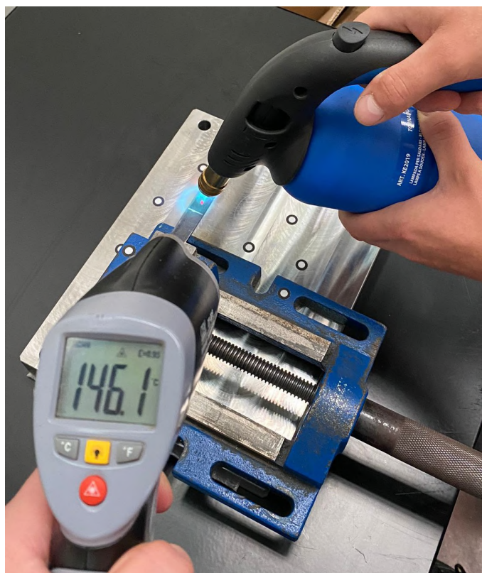
Slika 48: Lokalno zagrijavanje i mjerenje temperature [Varaždinske Toplice, 19. 8. 2022.]
