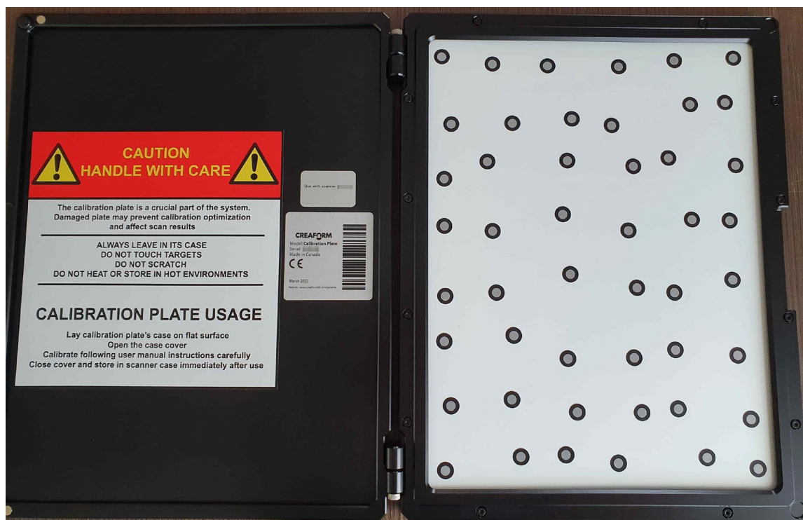
Slika 30: Kalibracijska ploča HandySCAN uređaja [Varaždinske Toplice, 16. 7. 2022.]
