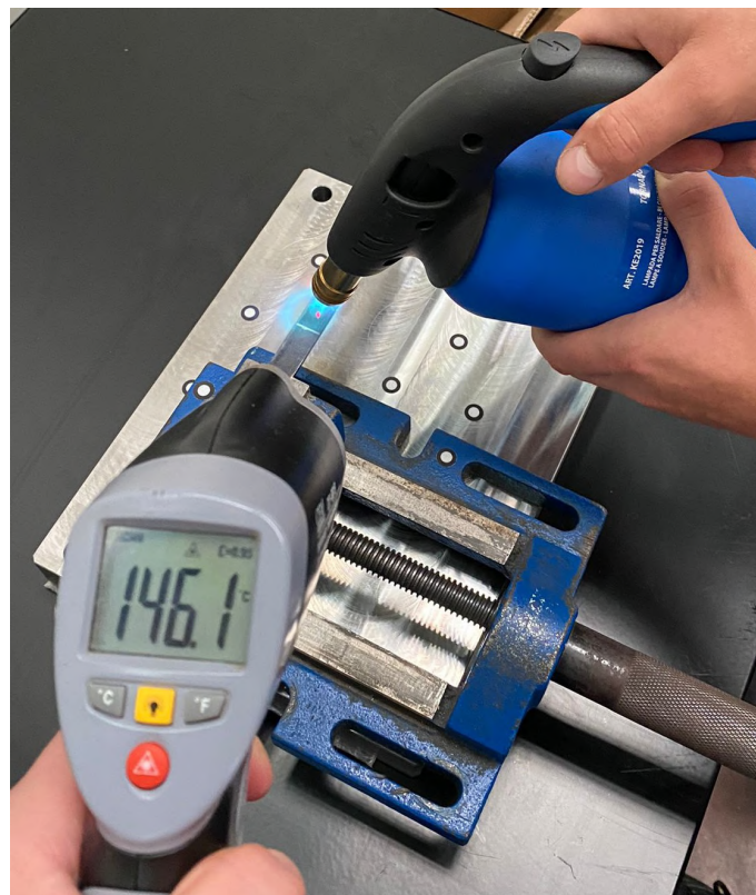
Slika 48: Lokalno zagrijavanje i mjerenje temperature [Varaždinske Toplice, 19. 8. 2022.]
