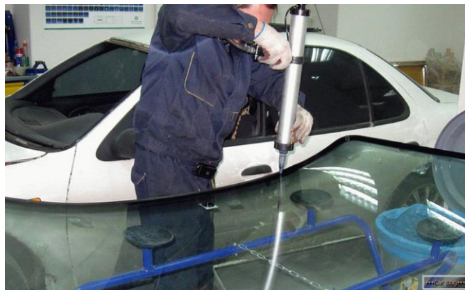
Slika 18. Primjer lijepljenja vjetrobranskog stakla [16]
