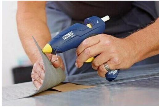
Slika 13. Pištolj za nanošenje ljepila [13]
