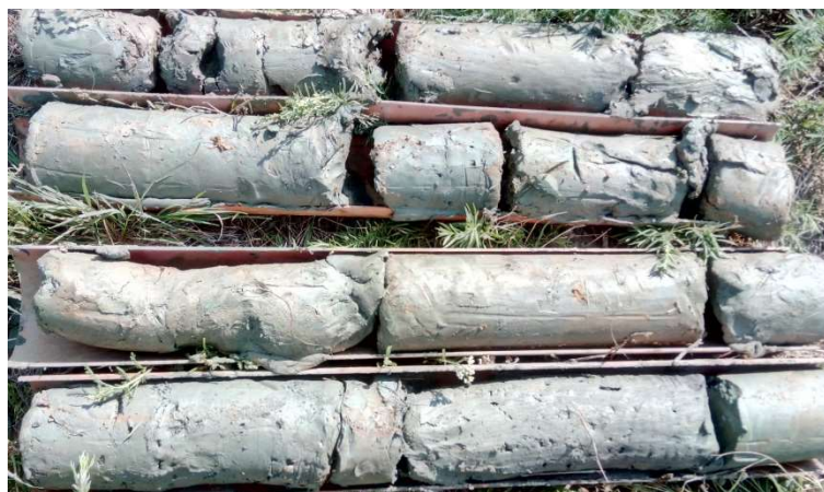
Slika 3.3.2. Nabušena jezgra bušotine B2
