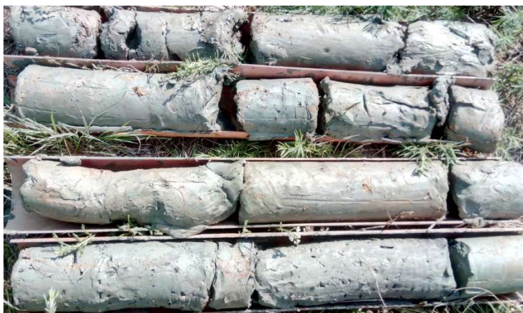
Slika 3.3.2. Nabušena jezgra bušotine B2
