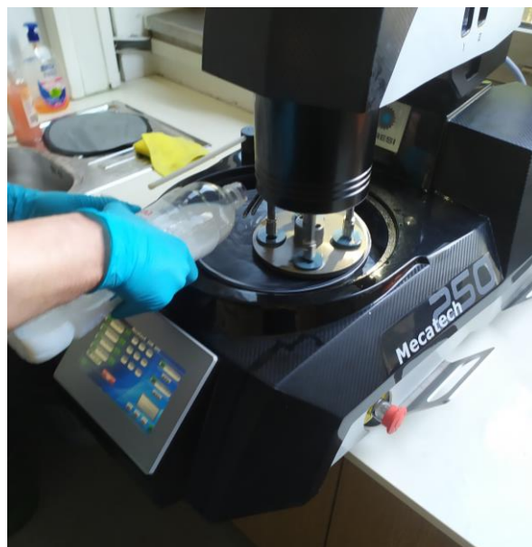
Slika 31. Ručno dodavanje SHIP-a tijekom poliranja
