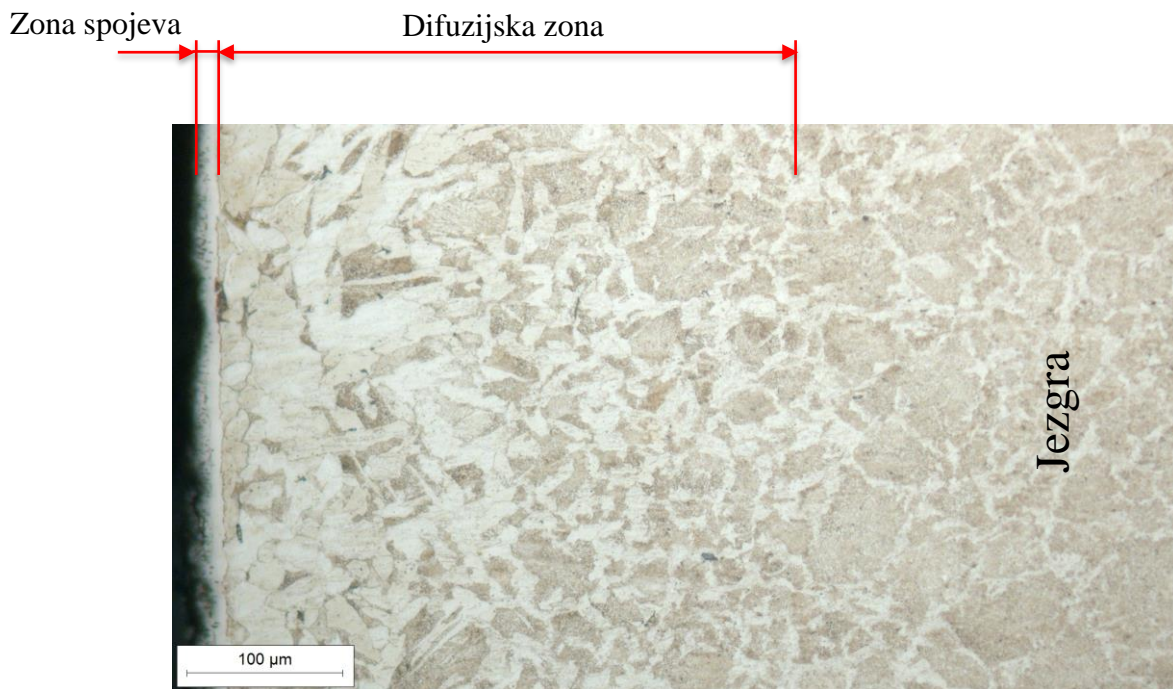
Slika 42. Mikrostruktura uzorka obrađenog tenifer postupkom (uvećanje 200x)
