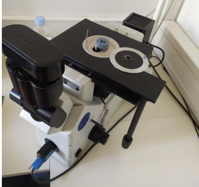
Slika 36. Olympus GX53 s DP23-CU digitalnom kamerom i uzorak pripremljen za analizu
