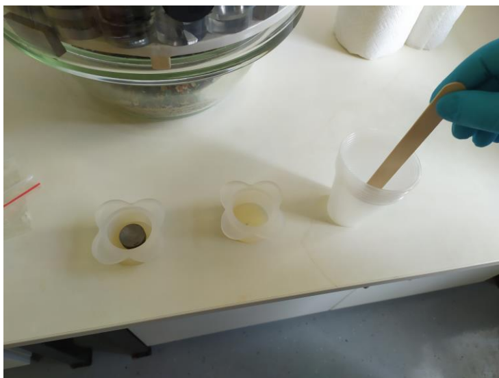
Slika 27. Pozicioniranje uzorka i ulijevanje smole u kalup
