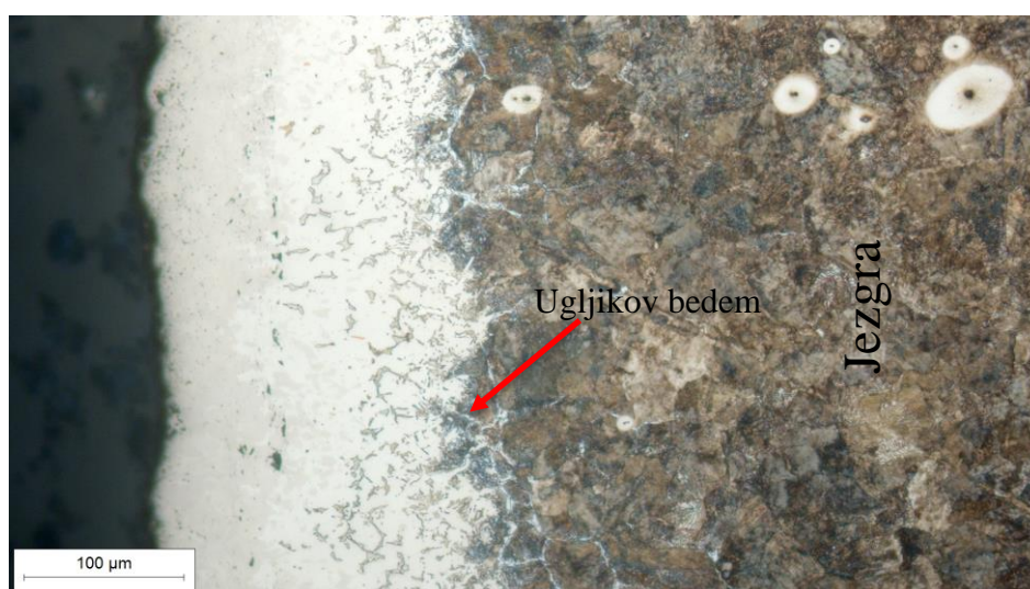
Slika 44. Mikrostruktura uzorka boriranog u čvrstom sredstvu EKABOR 3 (uvećanje 200x)
