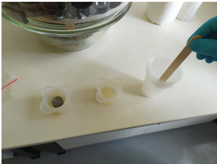
Slika 27. Pozicioniranje uzorka i ulijevanje smole u kalup
