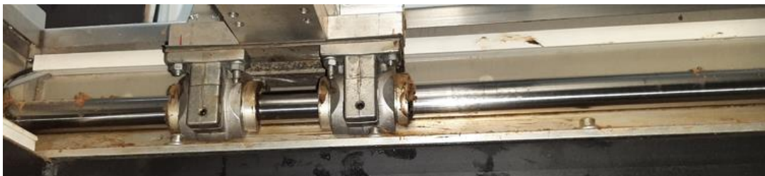
Slika 23 Cilindrična osovina i ležajevi za x-os
