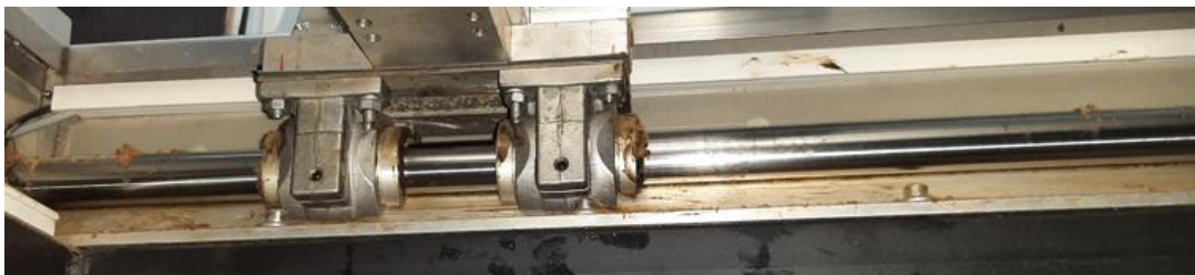
Slika 23 Cilindrična osovina i ležajevi za x-os
