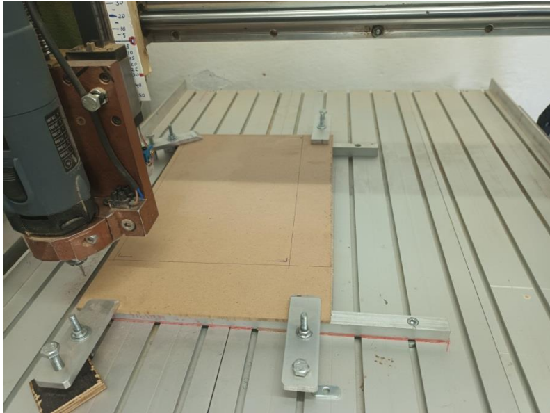
Slika 20 Stezanje obratka na radnom stolu
