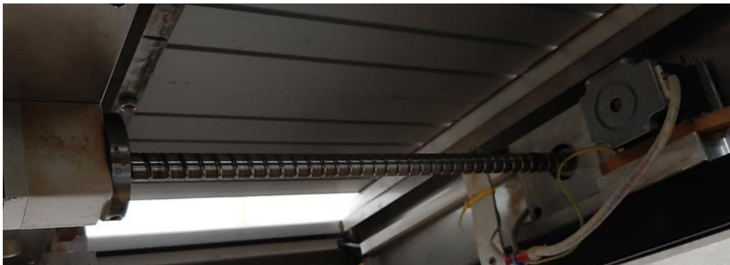
Slika 22 Navojno vreteno za x-os
