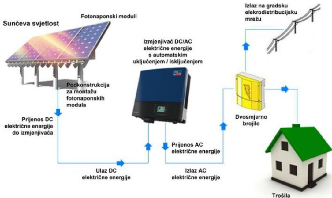
Slika 12. Shema On-grid sustava [7]
