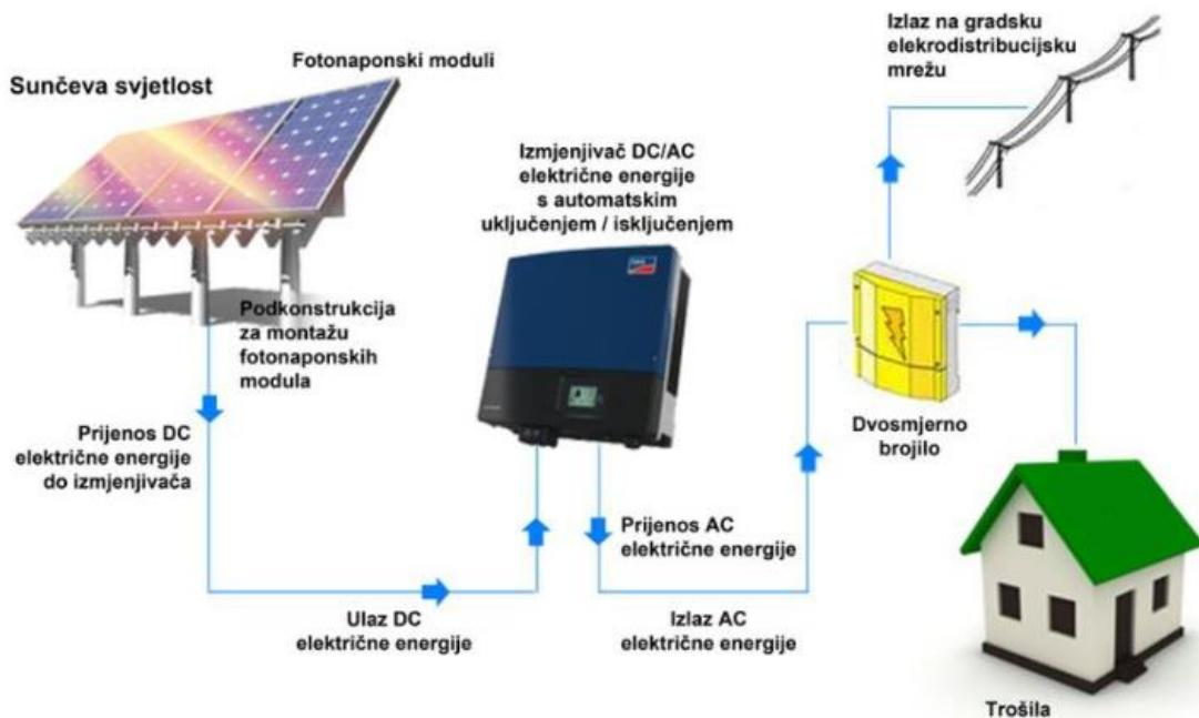
Slika 12. Shema On-grid sustava [7]
