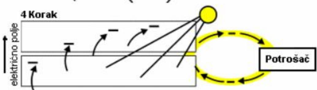
Slika 7. Princip rada fotonaponske čelije [3]
