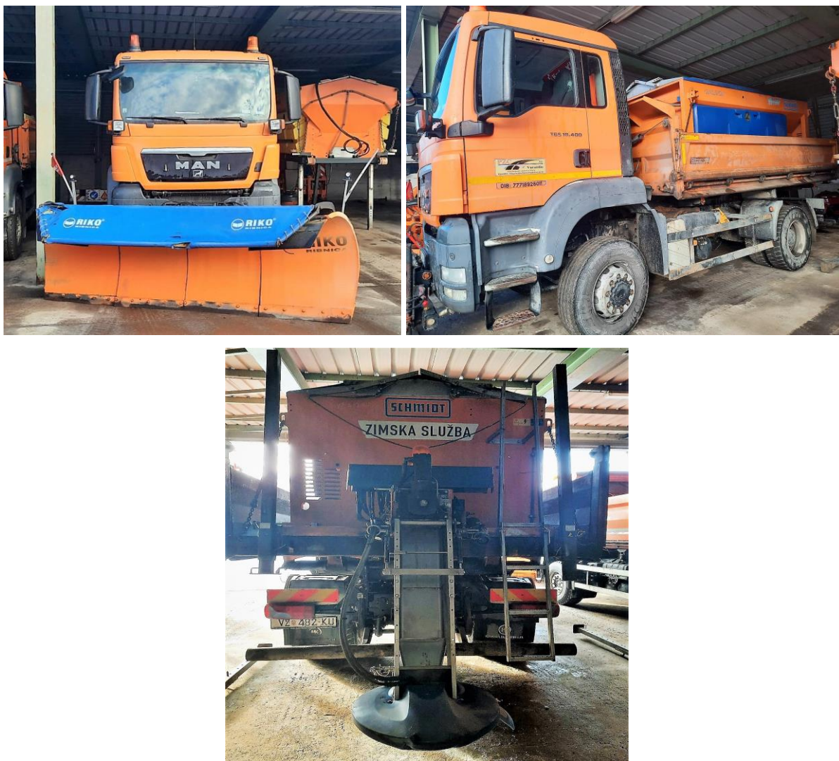
Slika 18. Teretno vozilo VŽ 482-KU opremljeno posipačem i snježnim plugom, pogled s prednje, bočne i stražnje strane [35]
