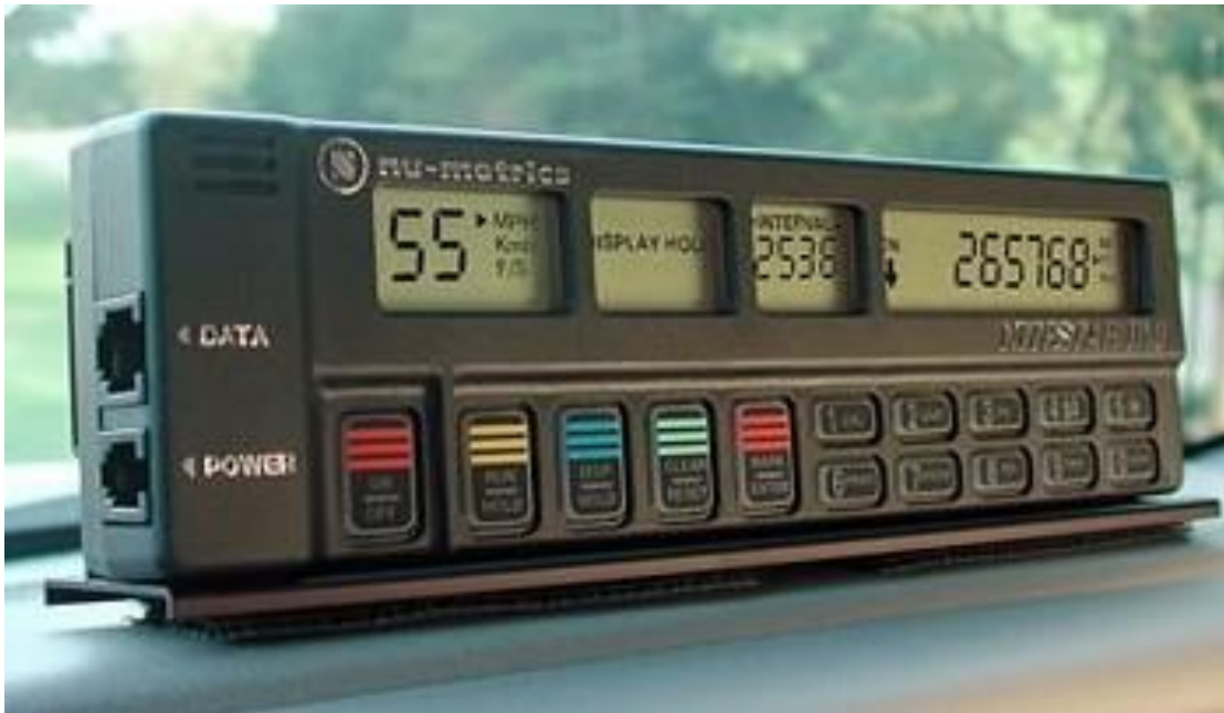
Slika 11. Digitalni mjerač udaljenosti NITESTAR NS-60 [27]
