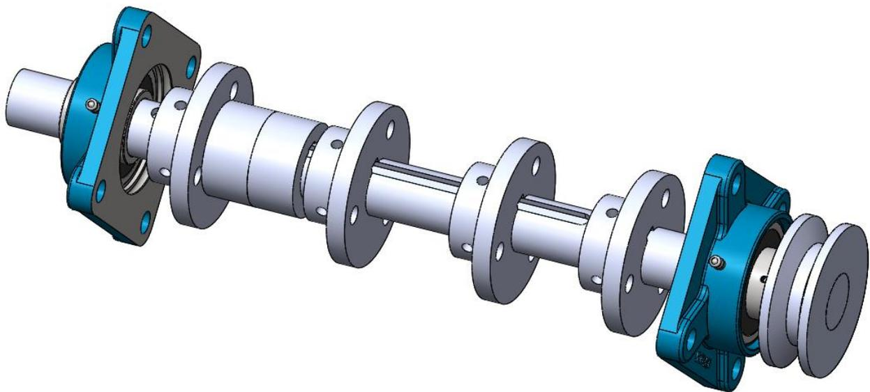
*Slika 21 Vratilo, glavčine, kućišta sa ležajevima i remenica*
