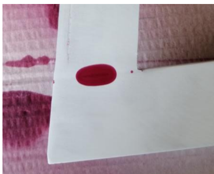
Slika 2.15 Indikacija otkrivena penetrantskom kontrolom
