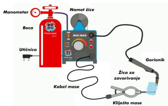
Slika 2.1 Oprema za MIG zavarivanje [4]
