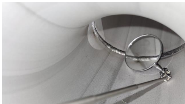
Slika 2.5 Indirektna vizualna kontrola
