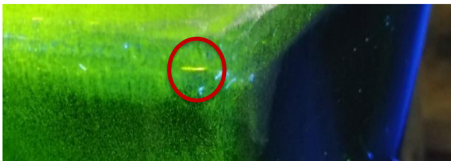
Slika 2.13 Indikacija u zavarenom spoju
