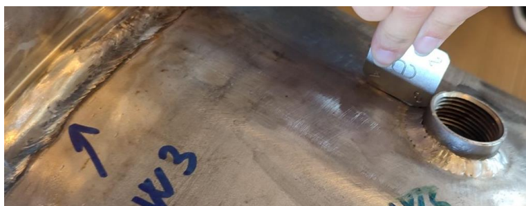
Slika 3.5 Mjerenje veličine zavora
