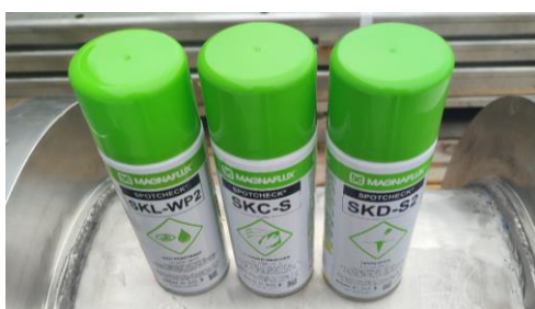
Slika 3.6 Sredstva za penetrantsko ispitivanje
