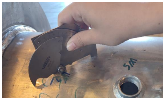
Slika 3.4 Mjerenje nadvišenja zavra
