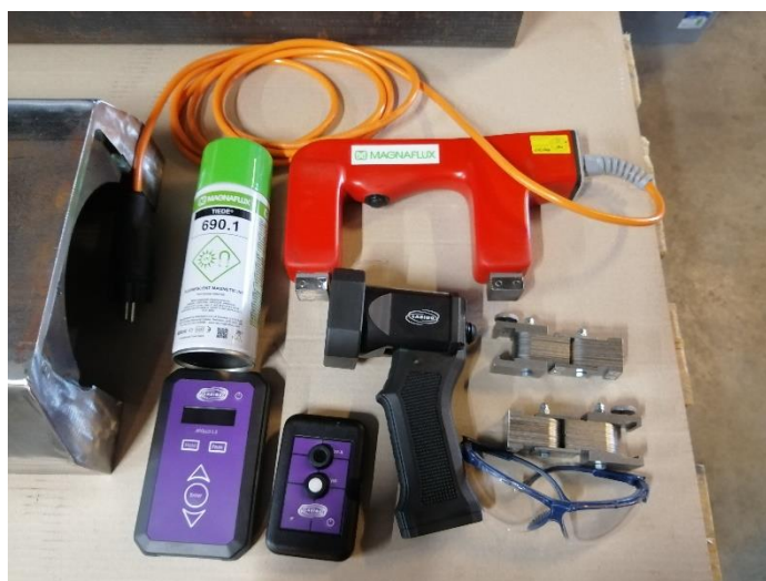
Slika 2.11 Potrebna oprema za magnetsku kontrolu zavarenih spojeva
