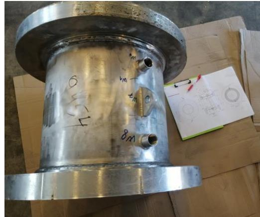
Slika 3.2 Označavanje zavara na konstrukciji
