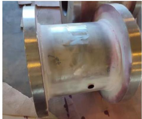
*Slika 3.9 Nanošenje razvijača na zavare*
