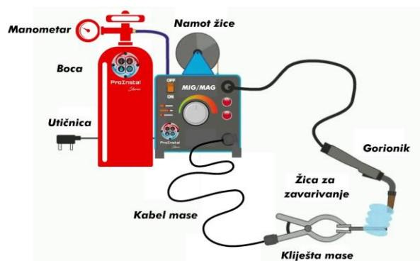
Slika 2.1 Oprema za MIG zavarivanje [4]
