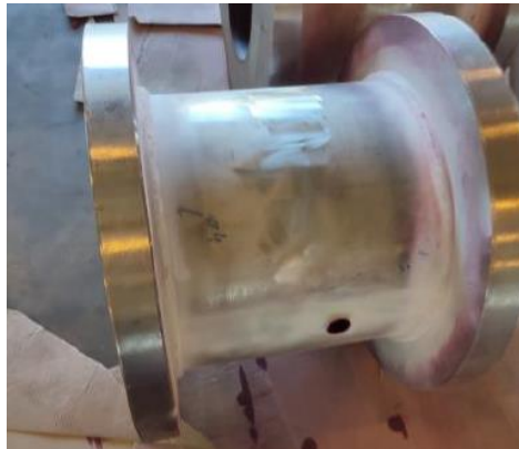
Slika 3.9 Nanošenje razvijača na zavare
