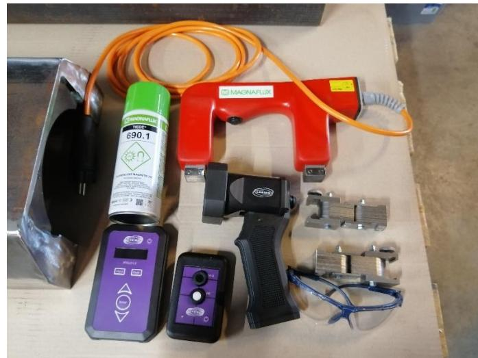
Slika 2.11 Potrebna oprema za magnetsku kontrolu zavarenih spojeva
