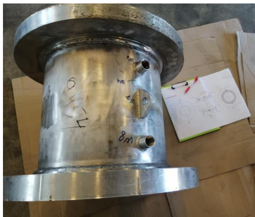
Slika 3.2 Označavanje zavara na konstrukciji
