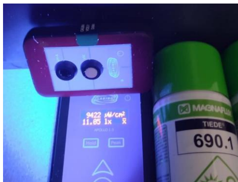
Slika 3.14 Mjerenje količine bijele i UV svjetlosti
