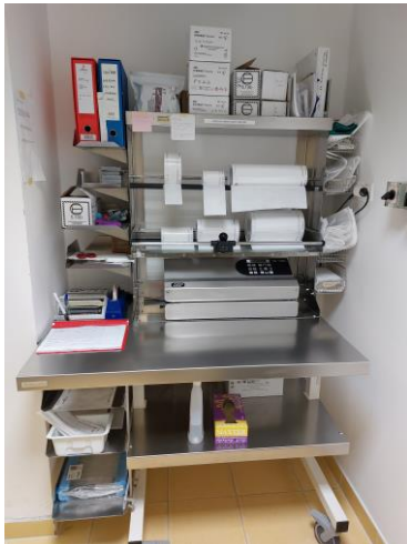
Slika 3.2.8. Stroj za pakiranje instrument folija za sterilizaciju plazmom vodikova peroksida (Izvor: L. B.)
