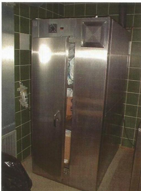
Slika 2.6.5.1. Ormar za prozračivanje etilen-oksida
