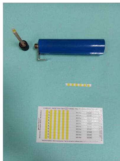
Slika 3.2.2. Bowie-Dick test (Izvor: L. B.)
