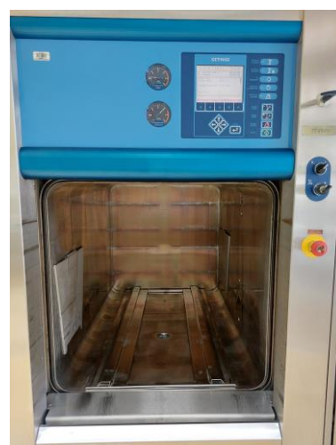
Slika 3.2.5. Unutrašnjost komore u autoklavu (Izvor: L. B.)
