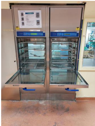
Slika 3.1.4. Termodezinfektori (Izvor: L. B.)
