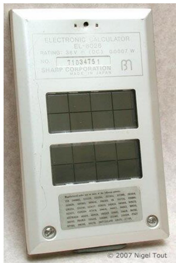
Slika 2.3 Prvi solarni kalkulator Sharp EL-8026 odzada gdje su solarne ćelije ( http://www.vintagecalculators.com/assets/images/SharpEL8026_3.jpg )
