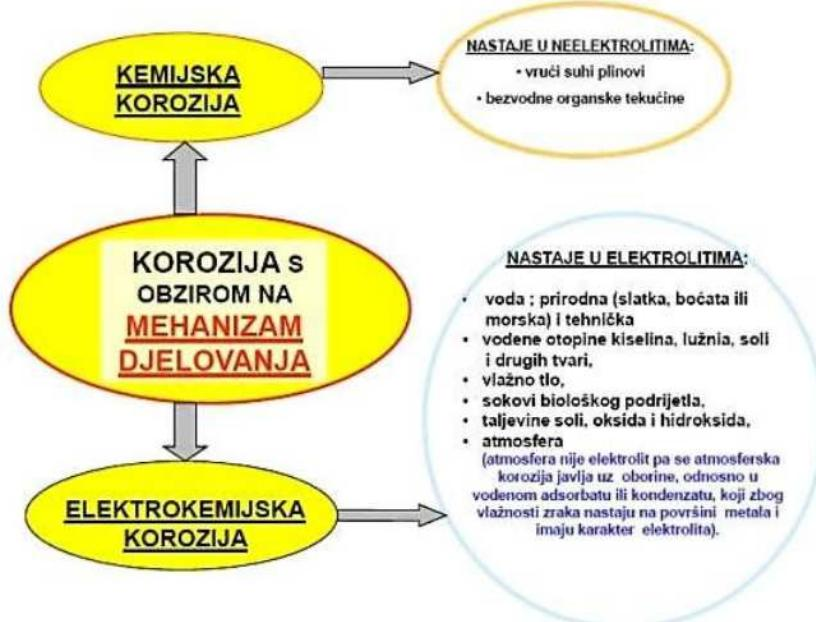
*Slika 3. Podjela korozije prema mehanizmu djelovanja [24]*
