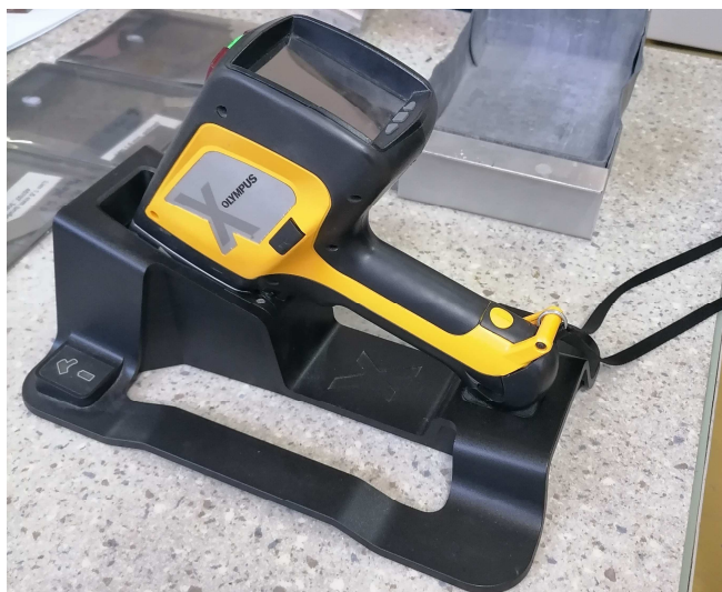
Slika 37. Uređaj XRF- Olympus
