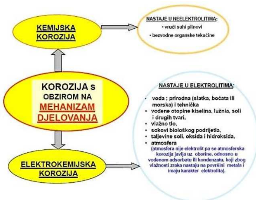
Slika 3. Podjela korozije prema mehanizmu djelovanja [24]
