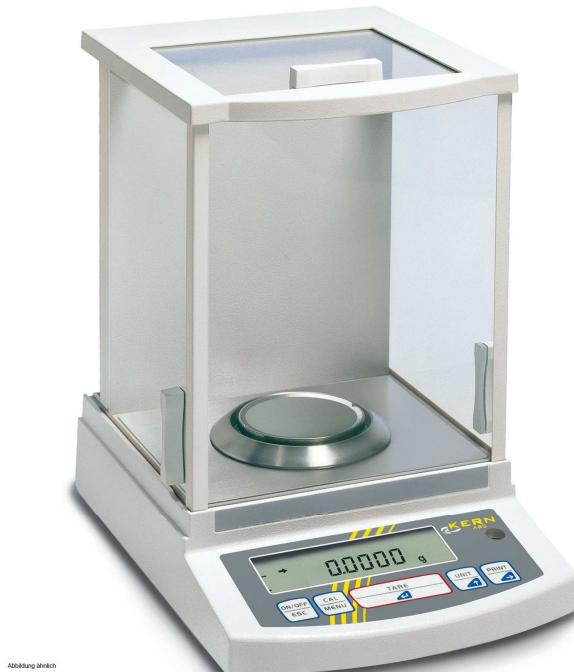
*Slika 38. Precizna analitička vaga za vaganje uzorka*
