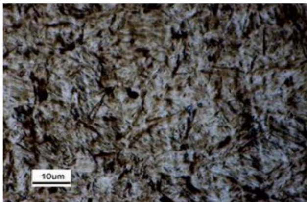
Slika 22. Mikrostruktura martenzitnih nehrđajućih čelika [4]
