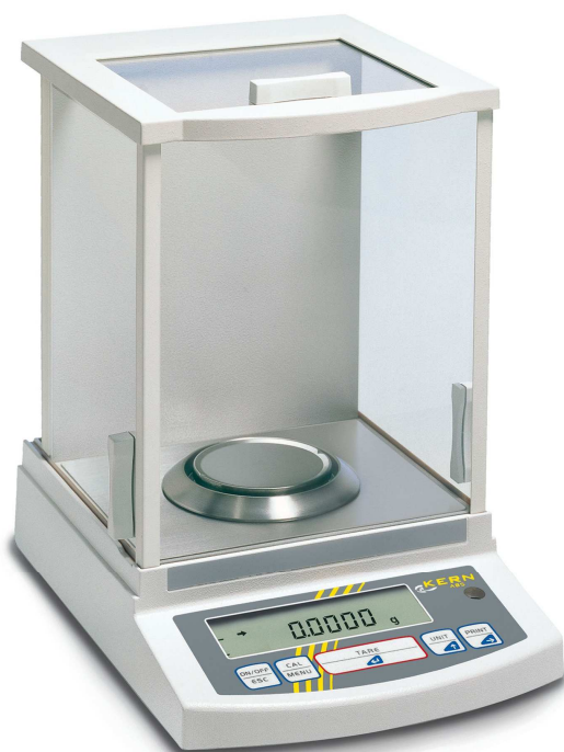
Slika 38. Precizna analitička vaga za vaganje uzoraka
