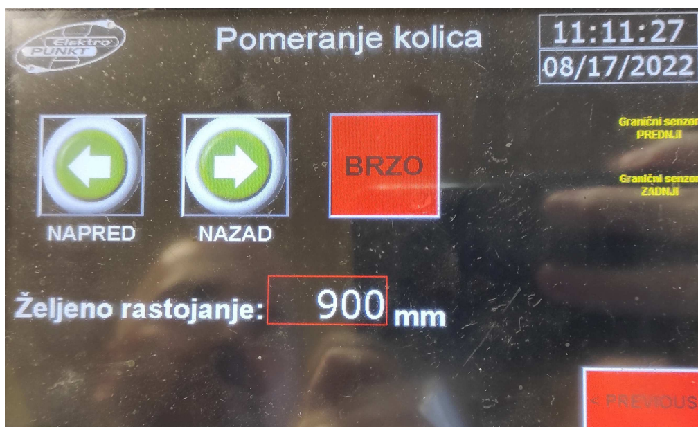
Slika 31. Ručno podešavanje kolica
