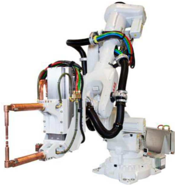
Slika 18. Prikaz robota za elektrootporno točkasto zavarivanje [2]
