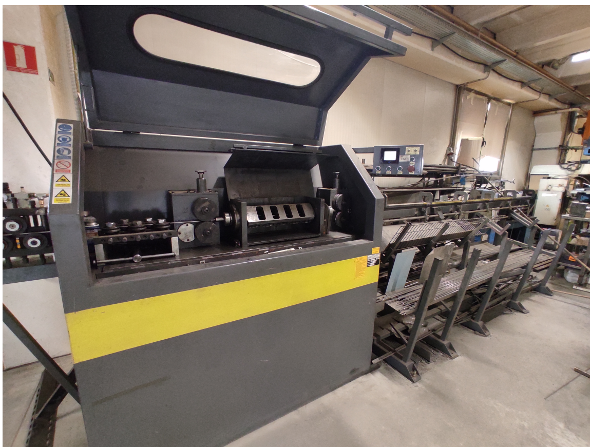
Slika 21. Stroj za ravnjanje i rezanje žice
