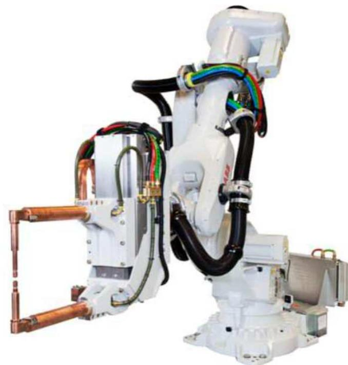
*Slika 18. Prikaz roboata za elektrootporno točkasto zavarivanje [2]*
