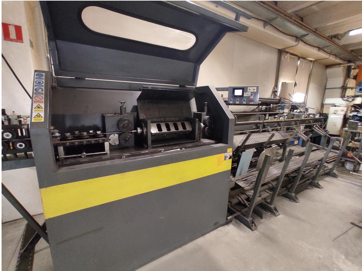
Slika 21. Stroj za ravnjanje i rezanje žice
