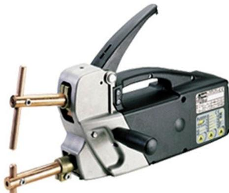
*Slika 11. Prikaz prenosivog stroja za elektrootporno točkasto zavarivanje*
