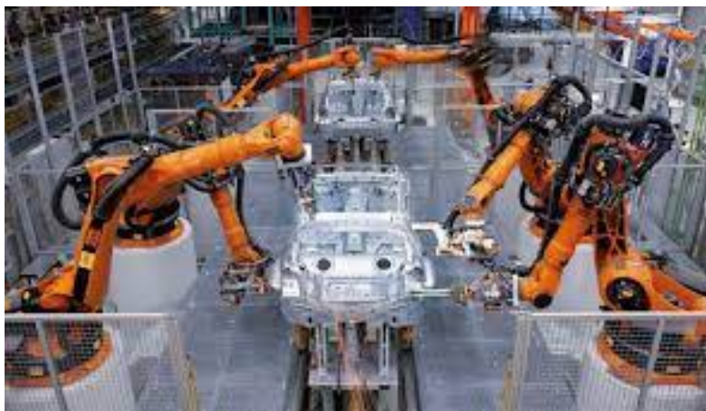
Slika 17. Prikaz elektrootpornog točkastog zavarivanja u automobilskoj industriji
