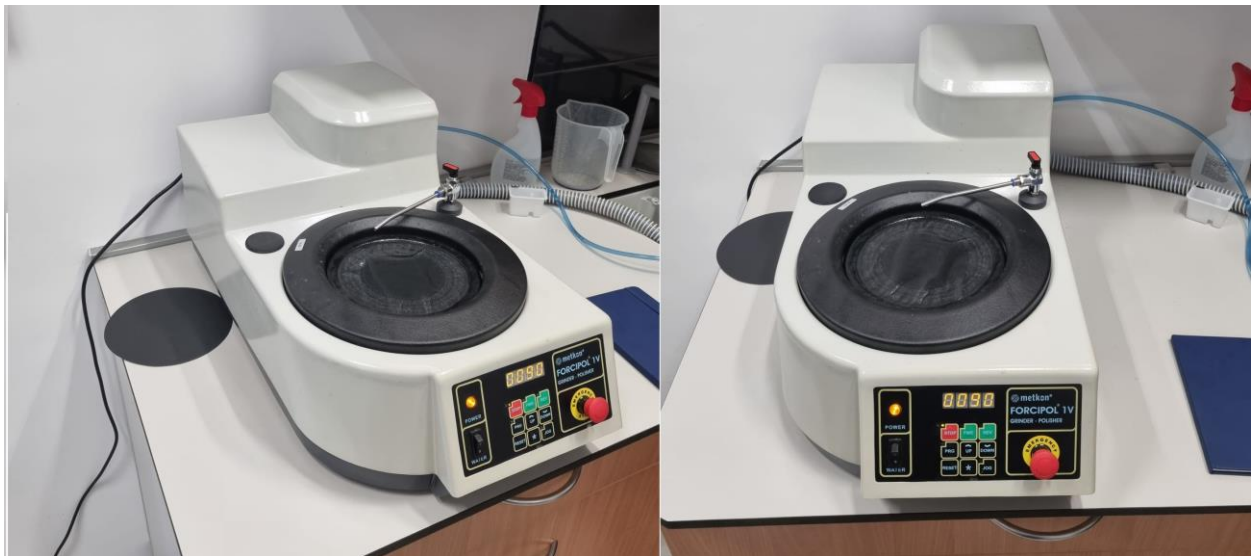
Slika 5.2 Uređaj za poliranje uzoraka
