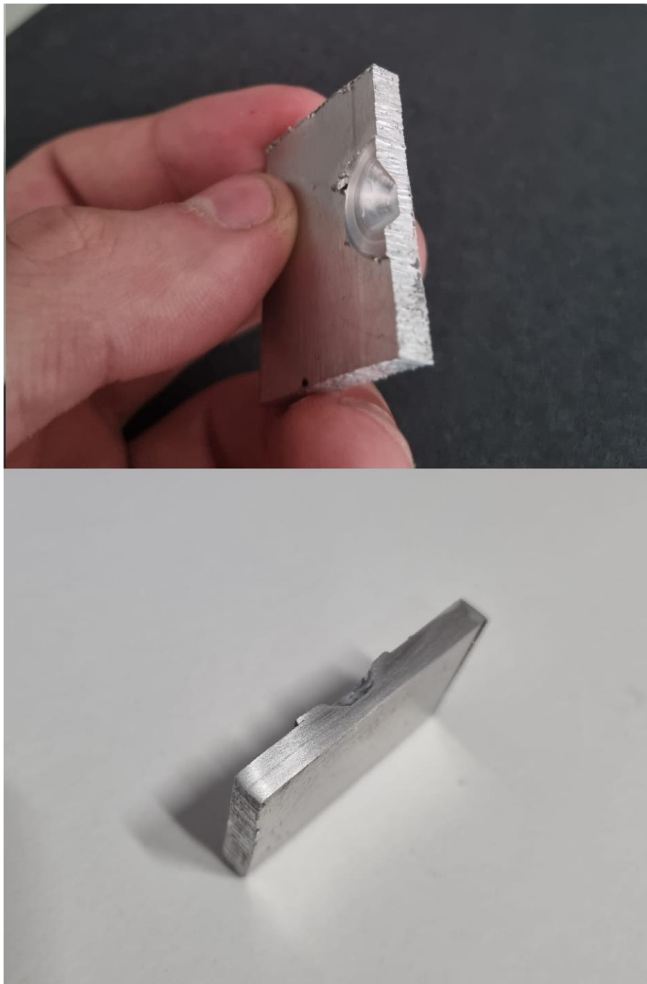
Slika 5.14 Izgled površine poprečnog presjeka uzorka prije i nakon brušenja
