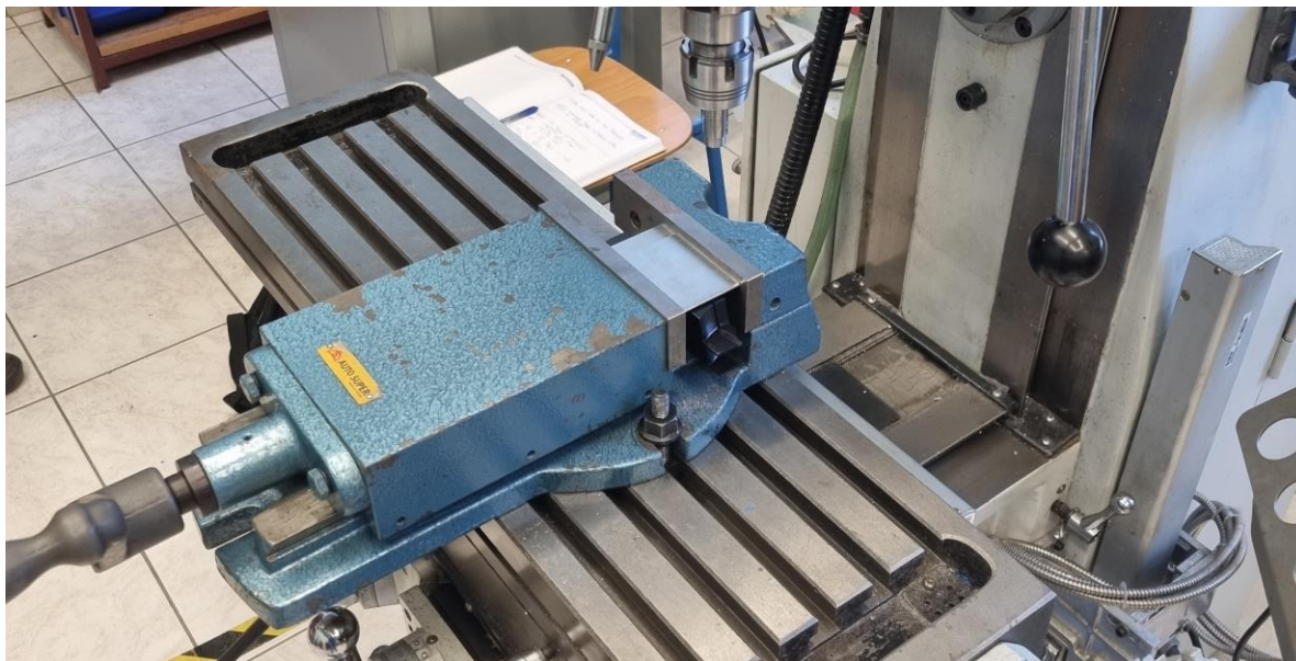
Slika 5.9 Uzorak stegnut u škripcu na glodalici
