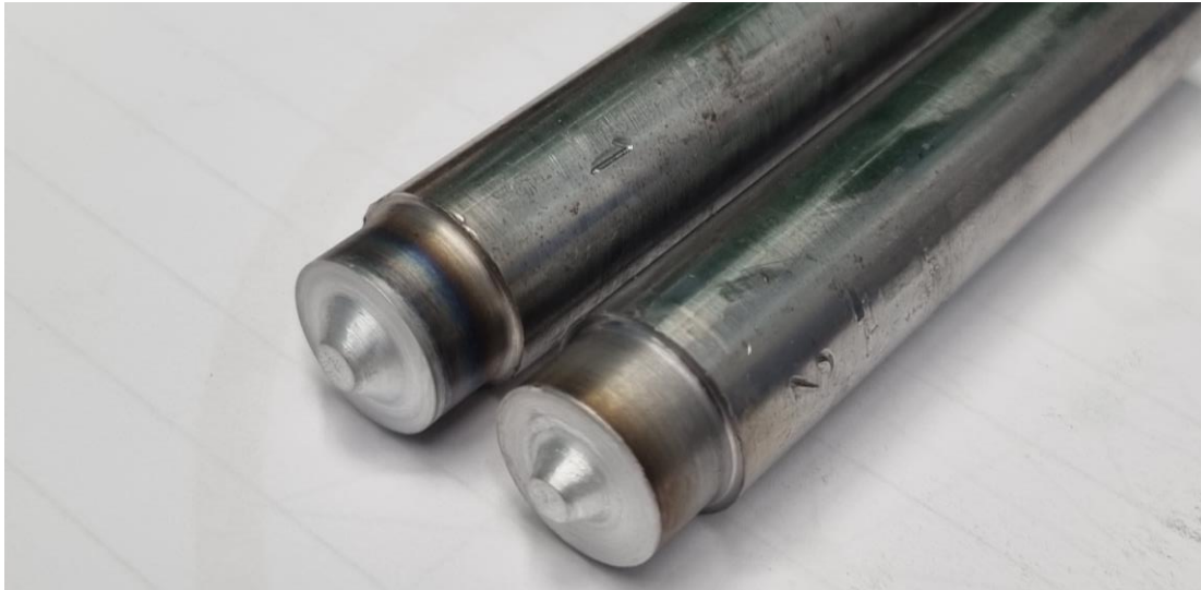
Slika 5.17 Izgled alata nakon zavarivanja
