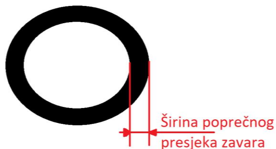
Slika 5.18 Shema izgleda zavara u tlocrtu
