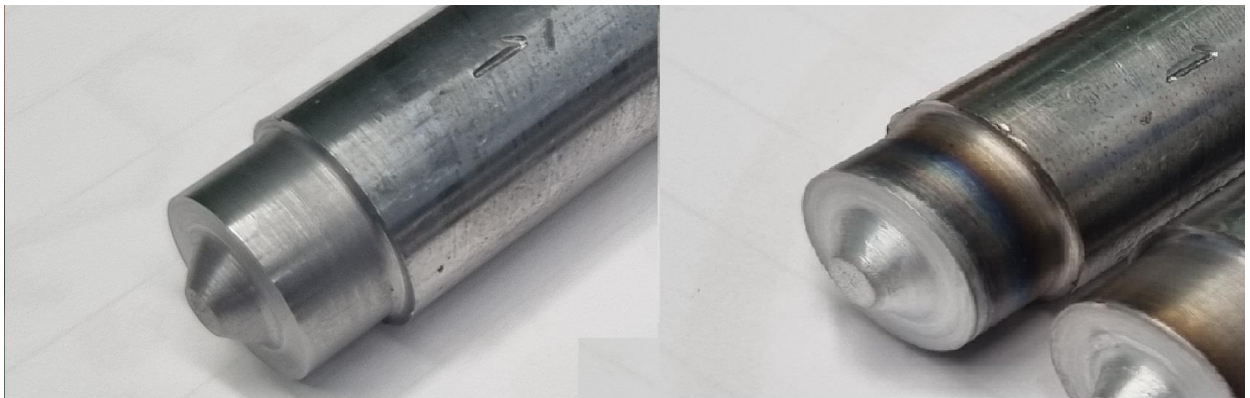
Slika 5.15 Utjecaj zavarivanja na alat (lijevo- prije, desno- nakon)
