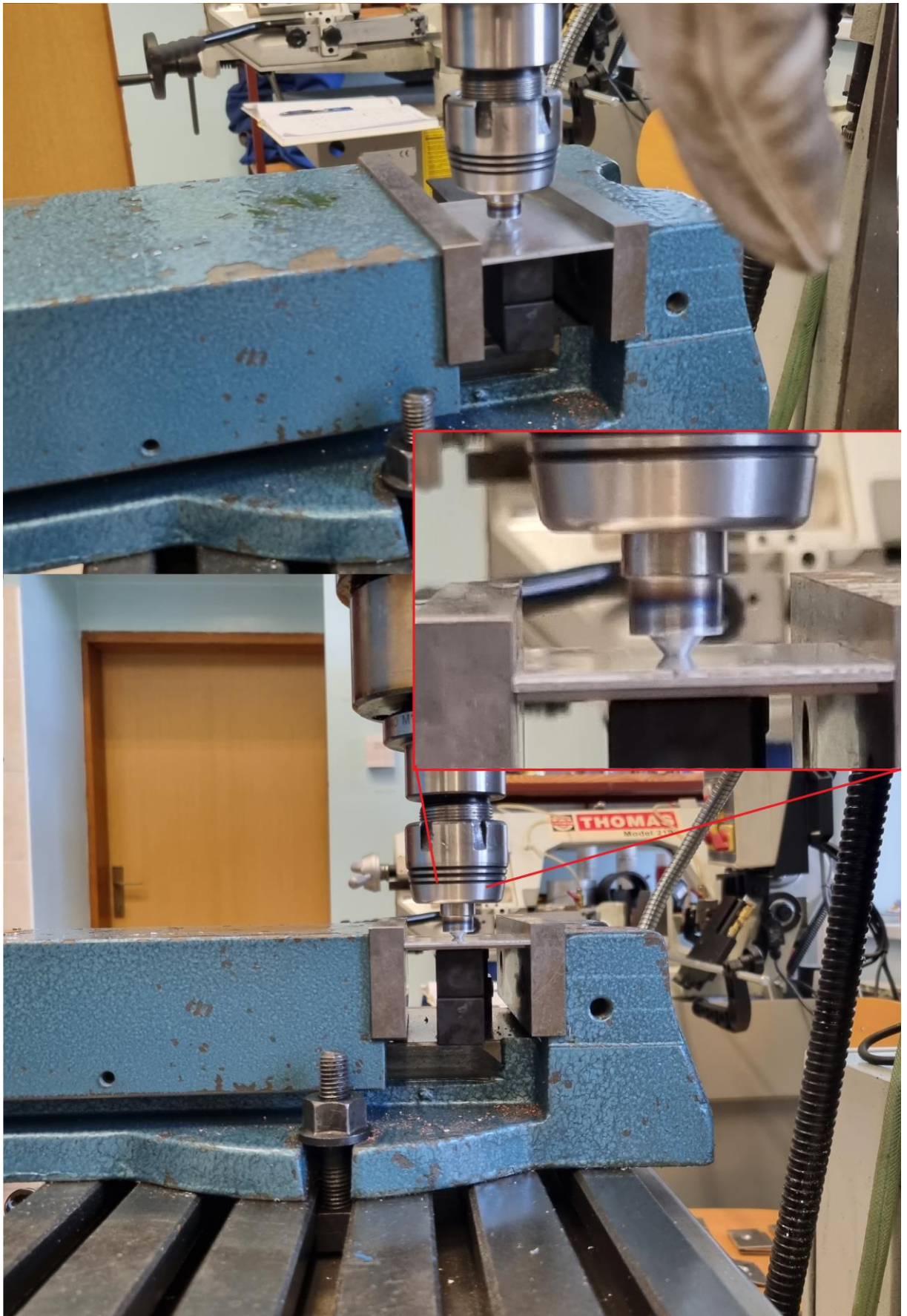
Slika 5.10 Dodir vretena s površinom uzorka
