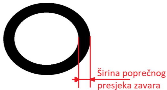
Slika 5.18 Shema izgleda zavara u tlocrtu
