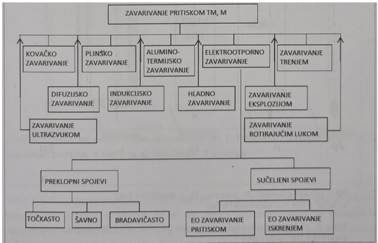
Slika 3.3 Podjela postupaka zavarivanja pritiskom [4]
