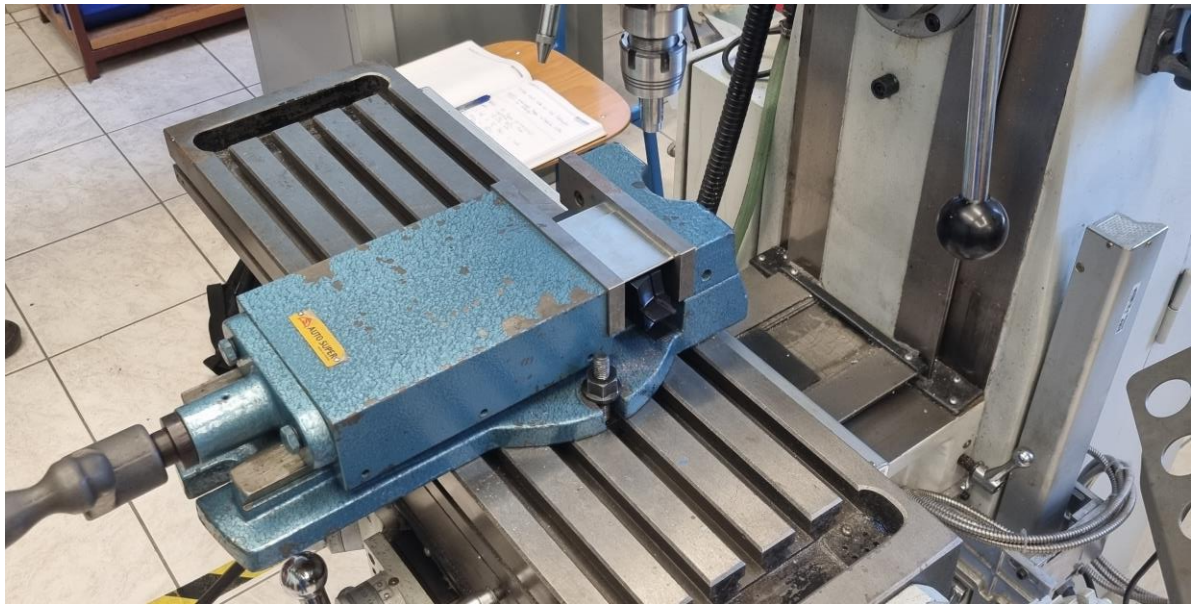
Slika 5.9 Uzorak stegnut u škripcu na glodalici
