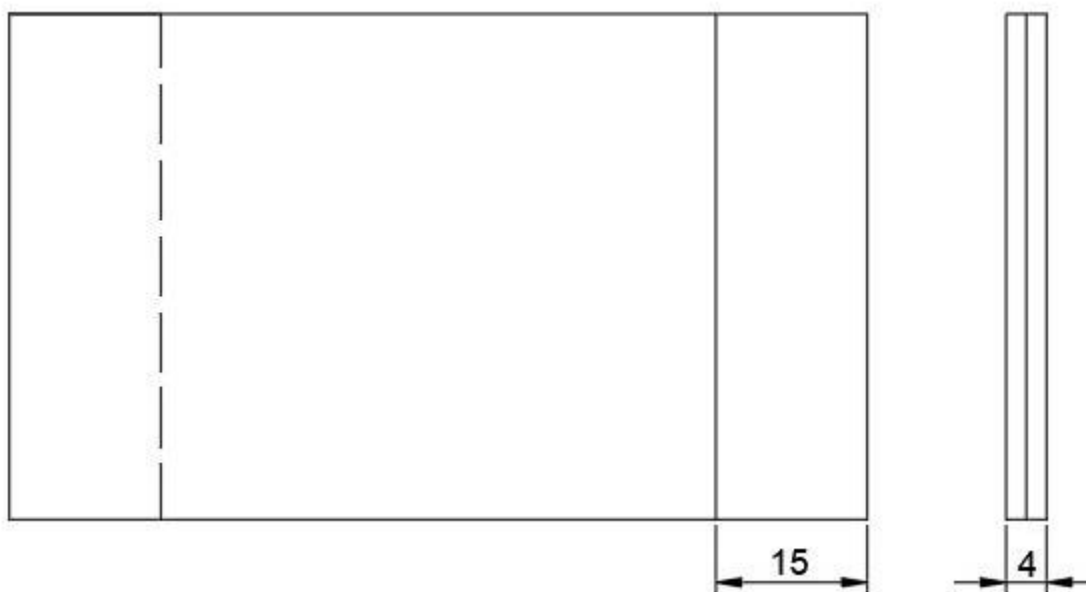
Slika 5.8 Izgled preklopnog spoja pločica
