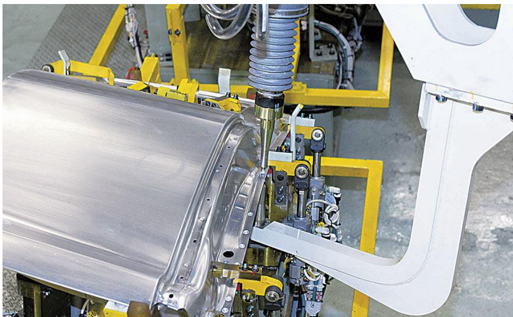
Slika 4.27 Robotsko FSSW zavarivanje u tvornici automobila [30]
