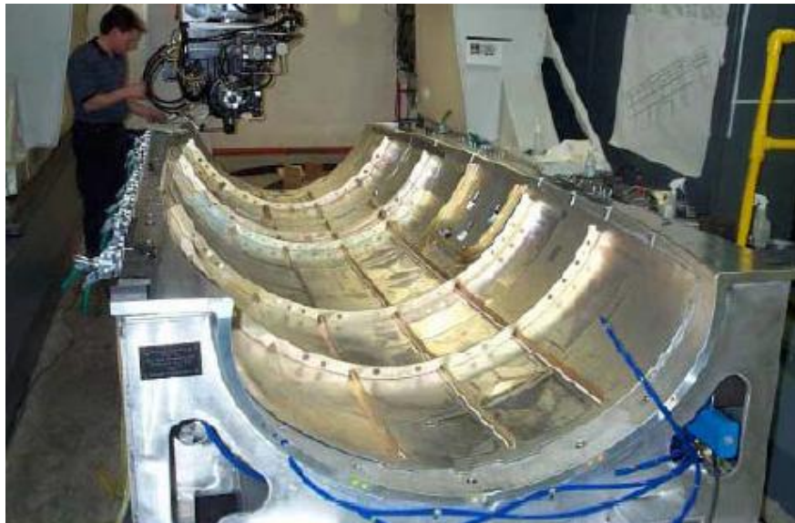
Slika 4.15. Zavarivanje stranica zrakoplova FSW postupkom [23]
