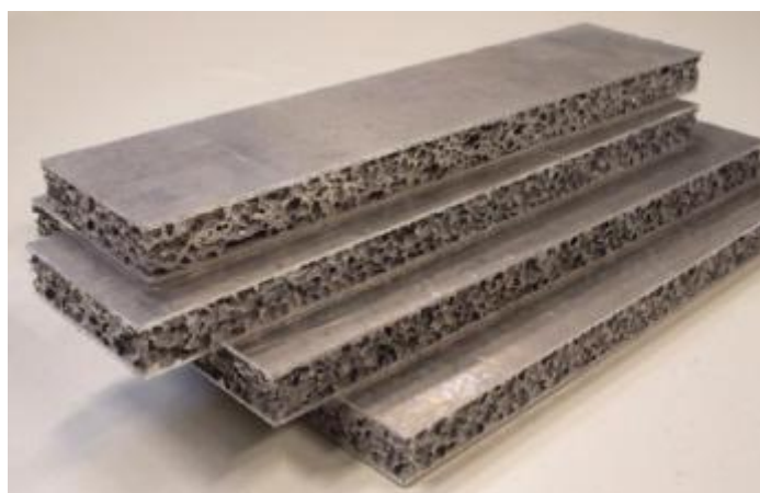
Slika 2.2. Aluminijski sendvič paneli s aluminijskom pjenom kao jezgrom [24]
