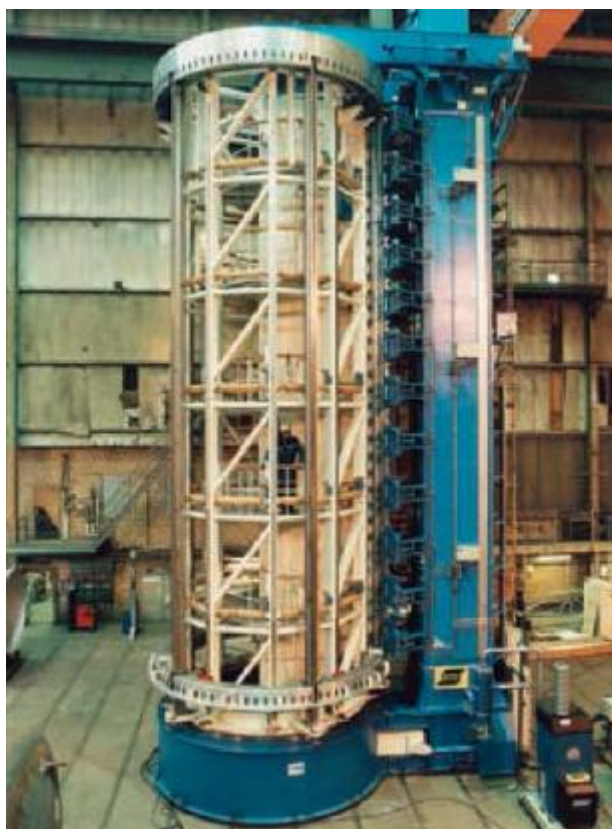
Slika 4.14. Izrada raketnih spremnika rezervoara za gorivo FSW postupkom u Boeingovom pogonu iz Delta programa u SAD-u [23]
