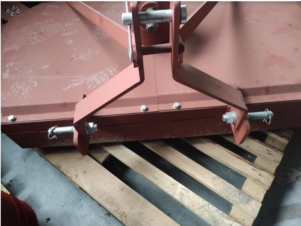
Slika 32 Priključak za traktor prototipa, 1.9.2022.
