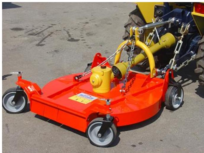
*Slika 2 Stražnja rotacijska ksilica za traktor*
