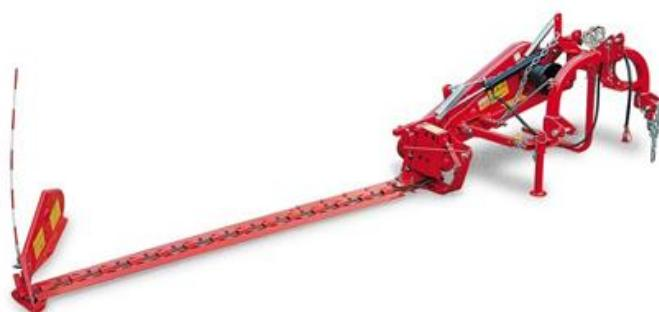
Slika 5 Oscilirajuća kosilica
