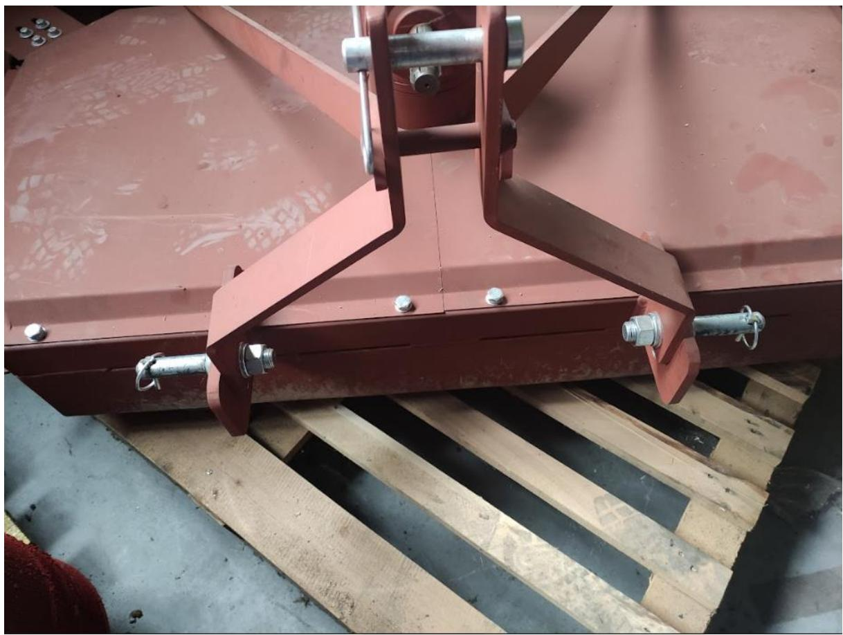
*Slika 32 Priključak za traktor prototipa, 1.9.2022.*
