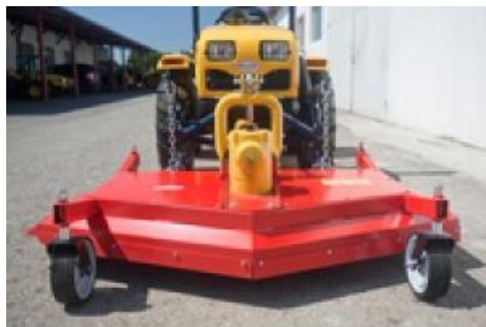
*Slika 3 Prednja rotacijska ksilica za traktor*
