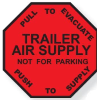
Slika 42. Gumb za dovod zraka u prikolicu [1]
