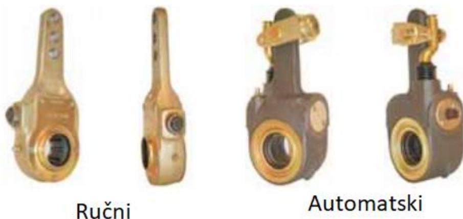
Slika 20. Ručne i automatske poluge kočnica [1]
