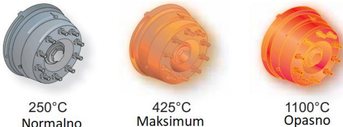
Slika 1. Izgled kočionih bubnjeva kod zagrijavanja [1]
