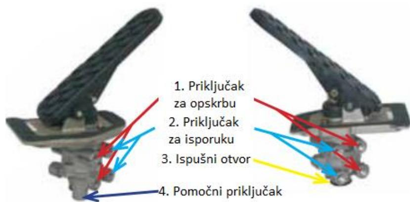
Slika 28. Papuča zračne kočnice [1]
