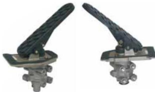
Slika 17. Nožni ventil ili papuča kočnice [1]
