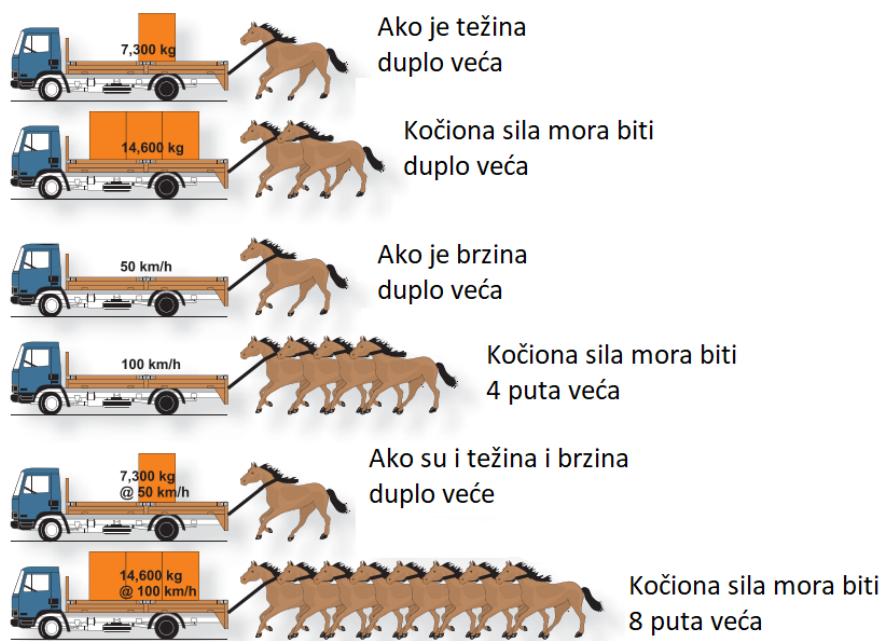
Slika 2. Promjena sile s obzirom na brzinu i težinu [1]
