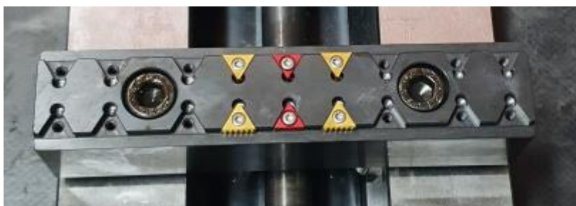
Slika 25 Čeljust za dvostruko stezanje
