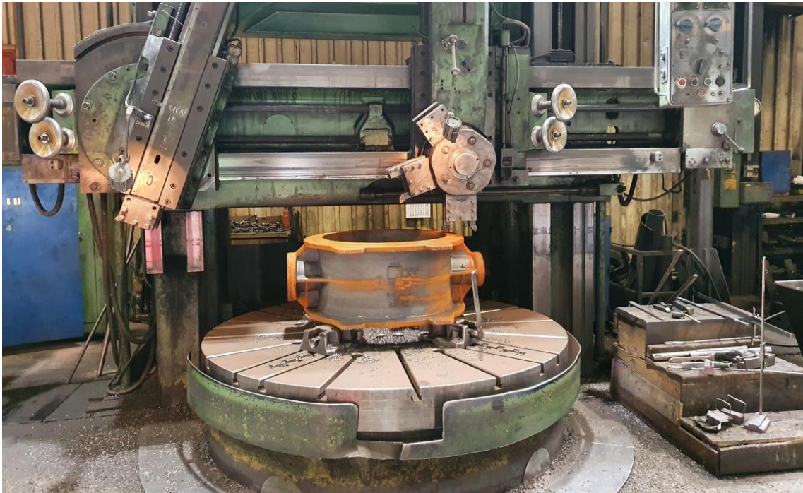
Slika 12 Stezanje kod tokarenja
