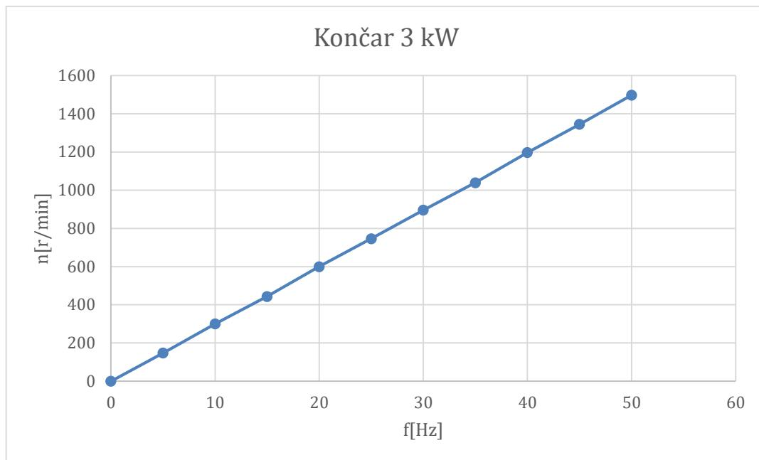
Slika 12. Ovisnost brzine o frekvenciji Končarevog motora
