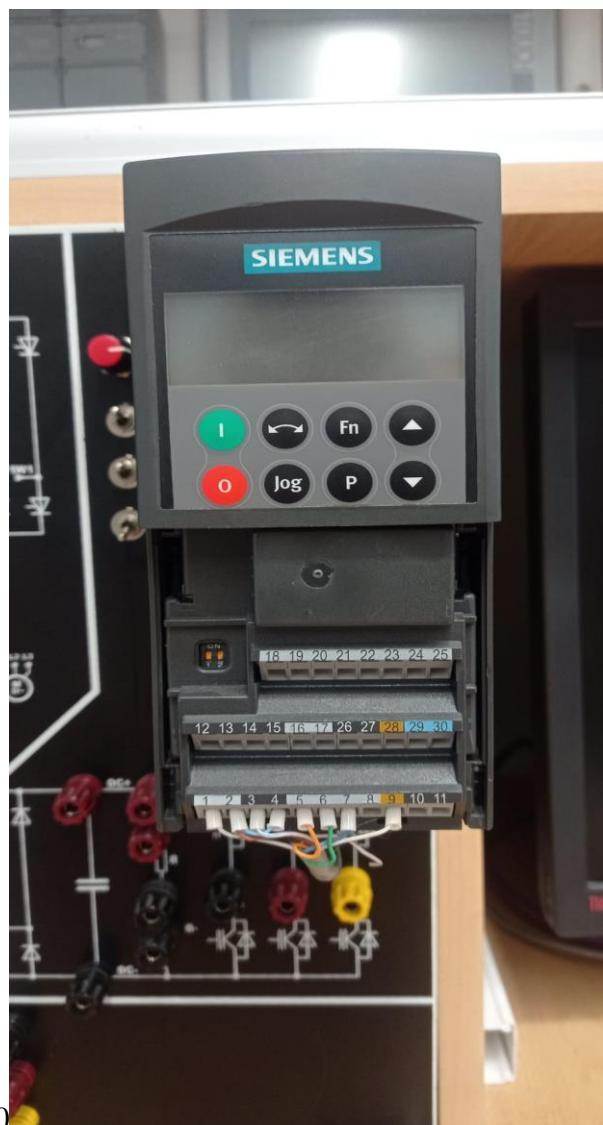
Slika 21. Izgled frekvencijskog pretvarača
