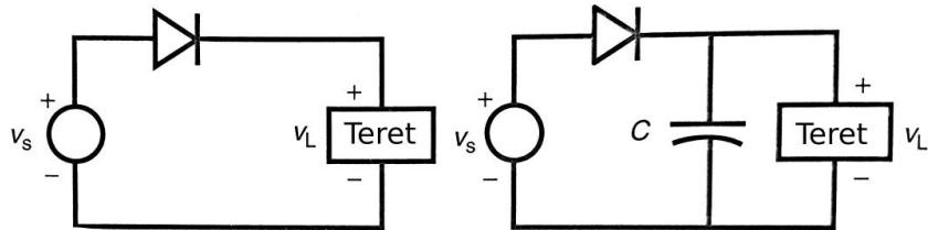
Slika 3. Poluvalni ispravljač sa i bez filtera [1]
