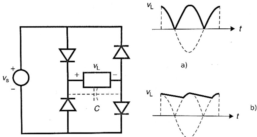
Slika 4. Punovalni ispravljač i prikaz napona na teretu bez filtera a) i sa filterom b) [1]
