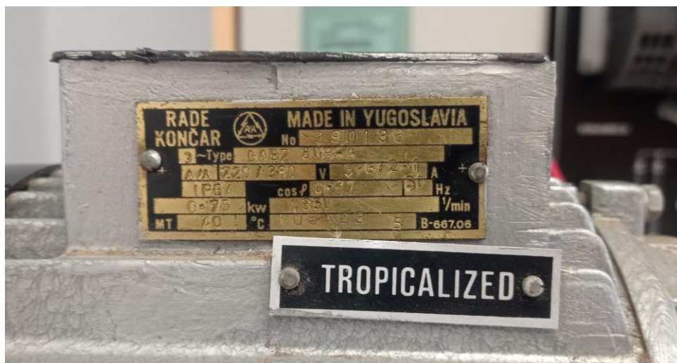
Slika 22. Pločica sa specifikacijama Končar 0.75 kW motora
