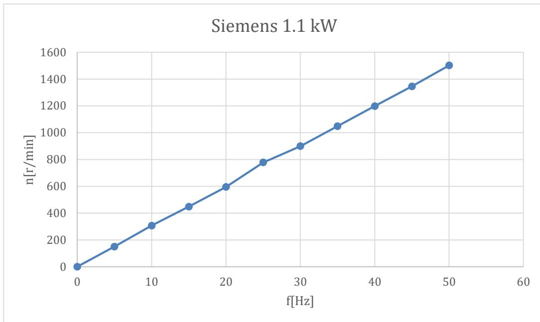
Slika 13. Ovisnost brzine o frekvenciji Siemensonovog motora
