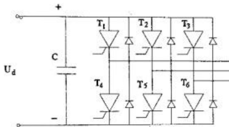
Slika 5. Naponski trofazni izmjenjivač [3]
