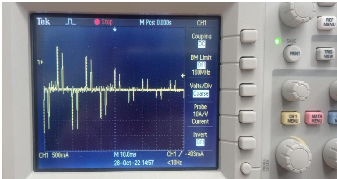
Slika 15. Prikaz struje frekvencijskog pretvarača kod brzog kočenja
