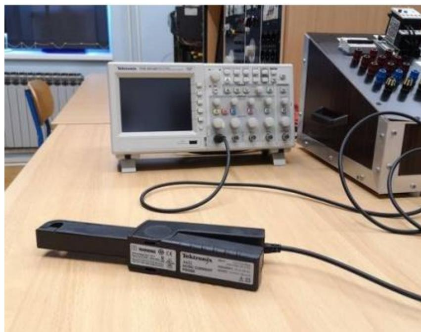
Slika 25. Osciloskop Tektronix TDS 2014B sa strujnim klijestima
