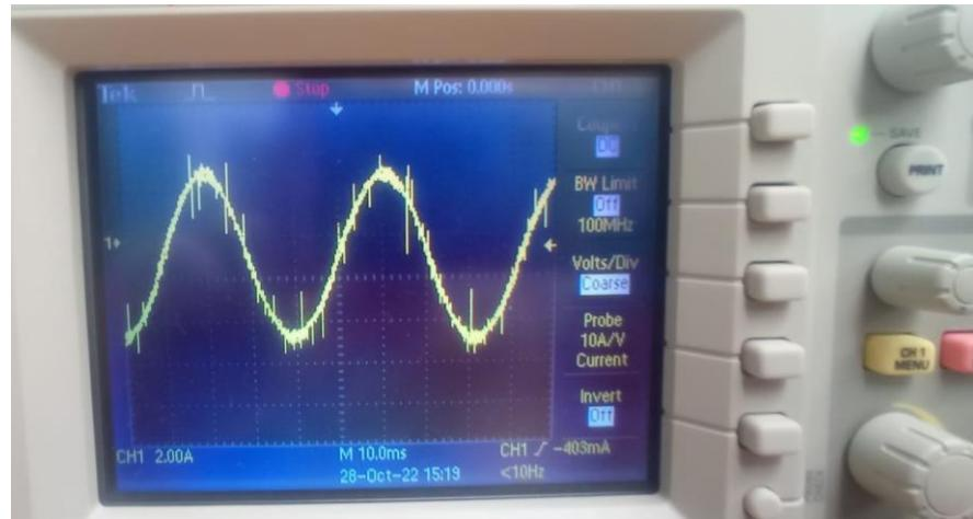
Slika 16. Prikaz struje u praznom hodu motora
