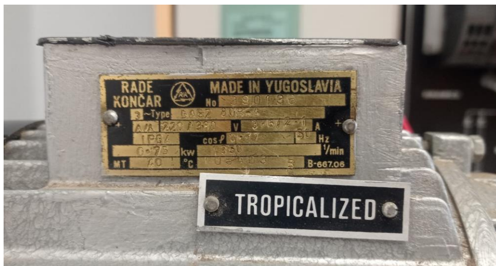
Slika 22. Pločica sa specifikacijama Končar 0.75 kW motora
