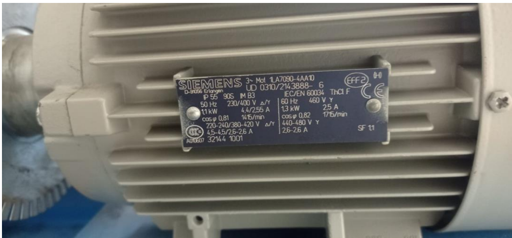
Slika 20. Pločica sa specifikacijama Siemens motora
