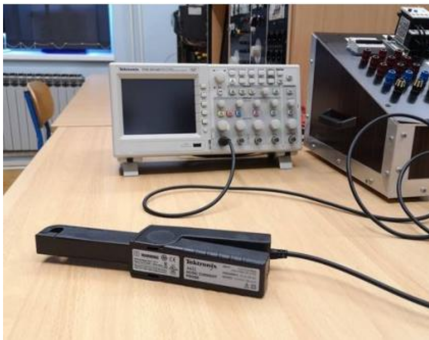
Slika 25. Osciloskop Tektronix TDS 2014B sa strujnim kliještima
