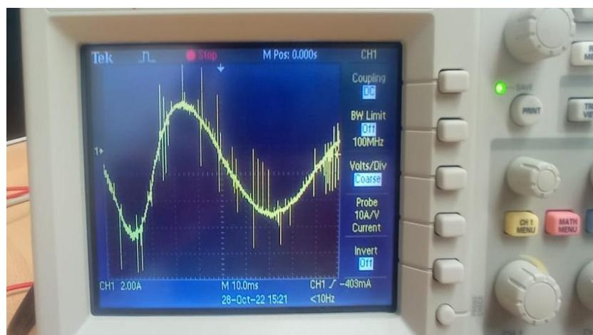
Slika 17. Prikaz struje pri brzom kočenju motora
