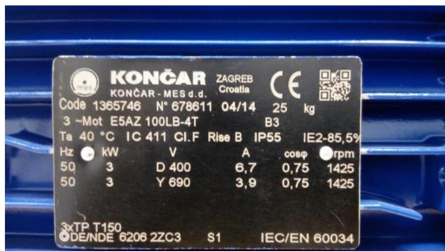
Slika 30. Pločica sa specifikacijama Končar 3 kW motora
